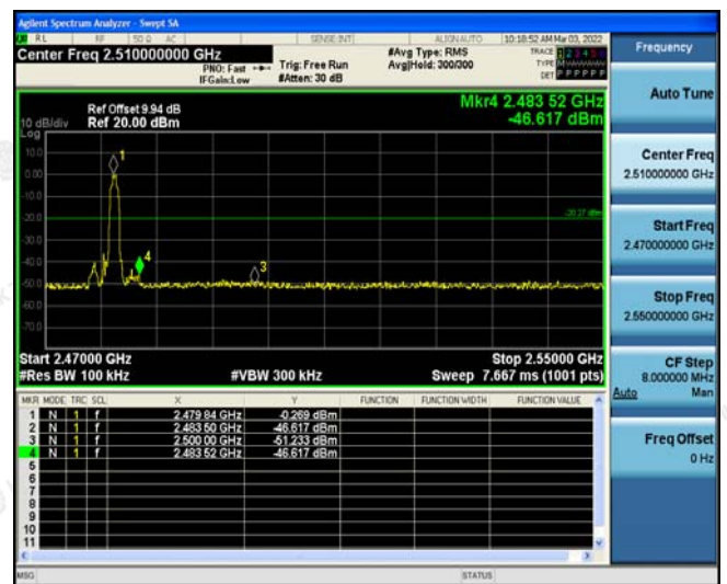
Right Band edge hopping off
