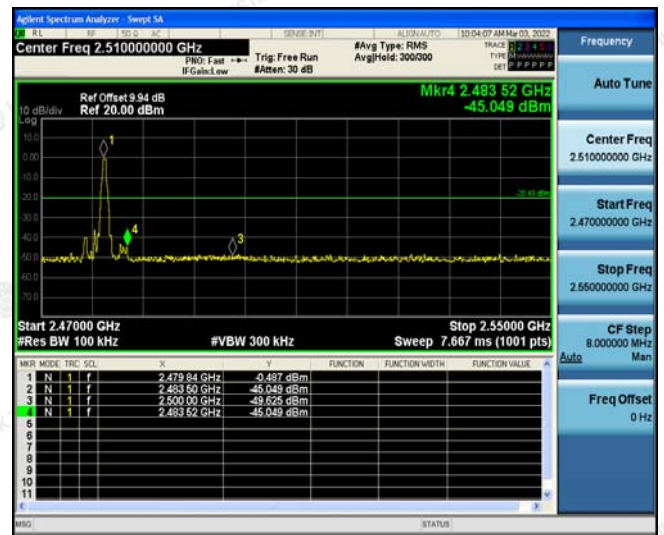
Right Band edge hopping off
