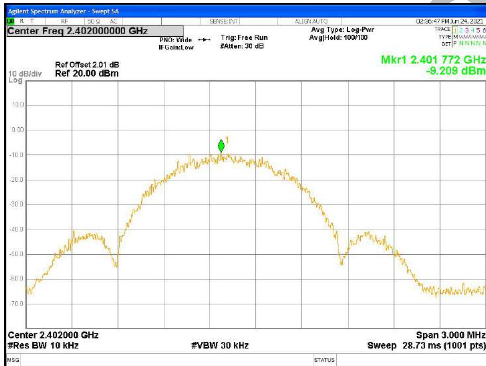
PSD NVNT BLE 1M 2442MHz Ant1
