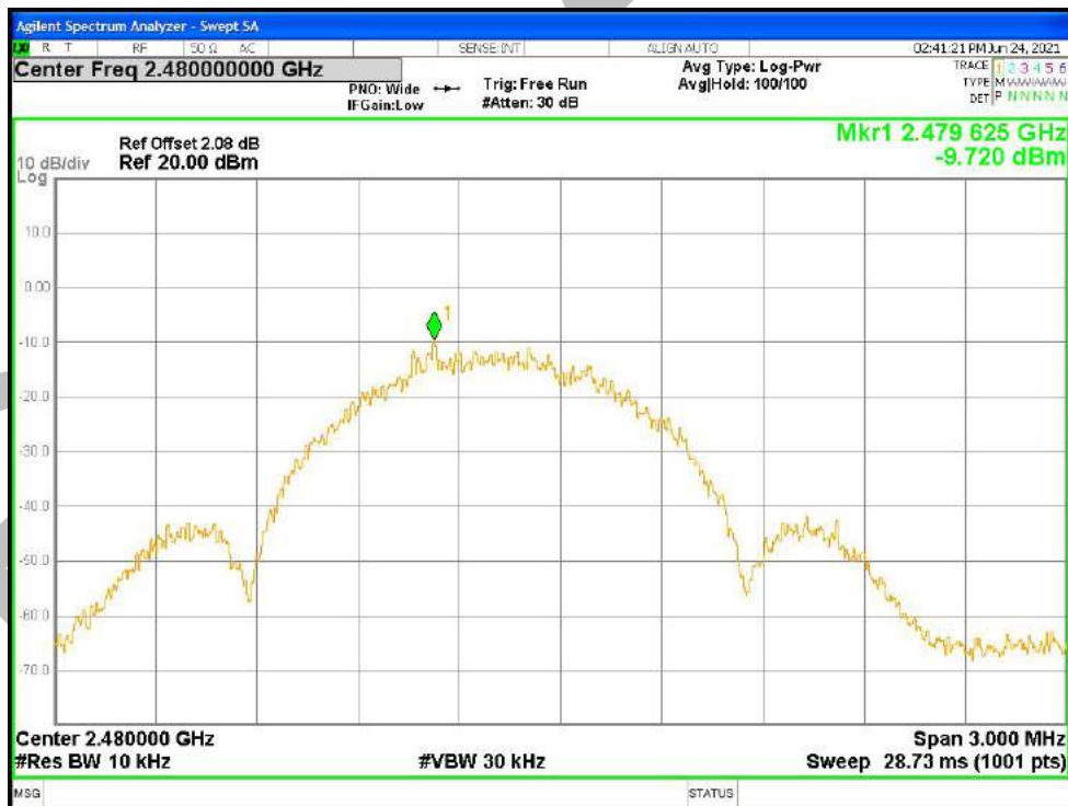
PSD NVNT BLE 1M 2480MHz Ant1
