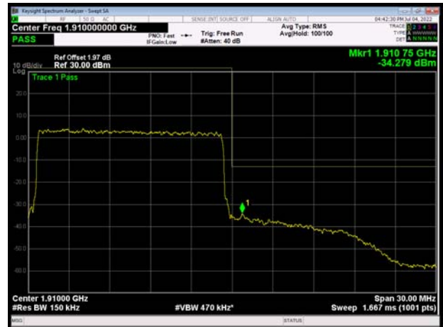
LTE Band 2 20MHz QPSK 1RB CH-High
