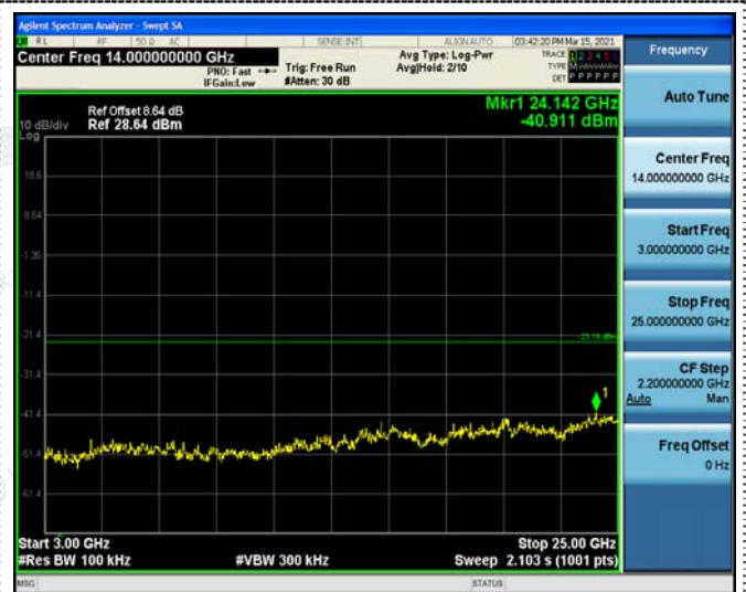
Right Band edge hopping on
