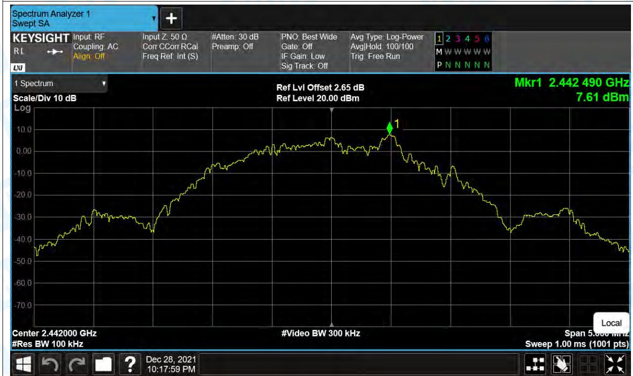
Tx. Spurious NVNT BLE 2Mbps 2442MHz Ant1 Emission
