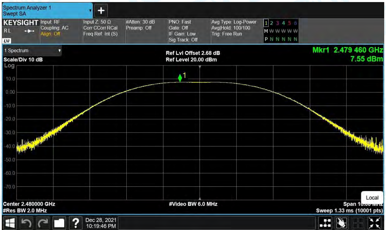
Power NVNT BLE 2Mbps 2480MHz Ant1
