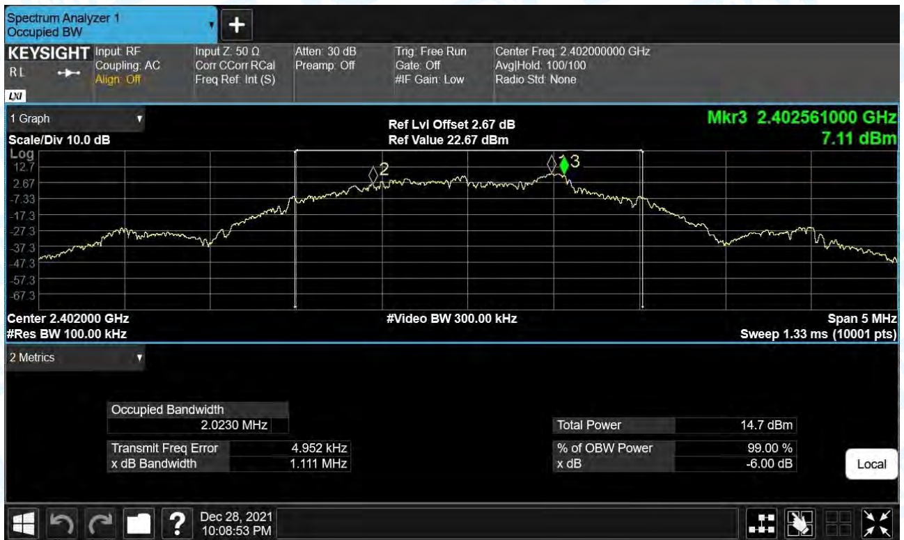
-6dB Bandwidth NVNT BLE 2Mbps 2402MHz Ant1
