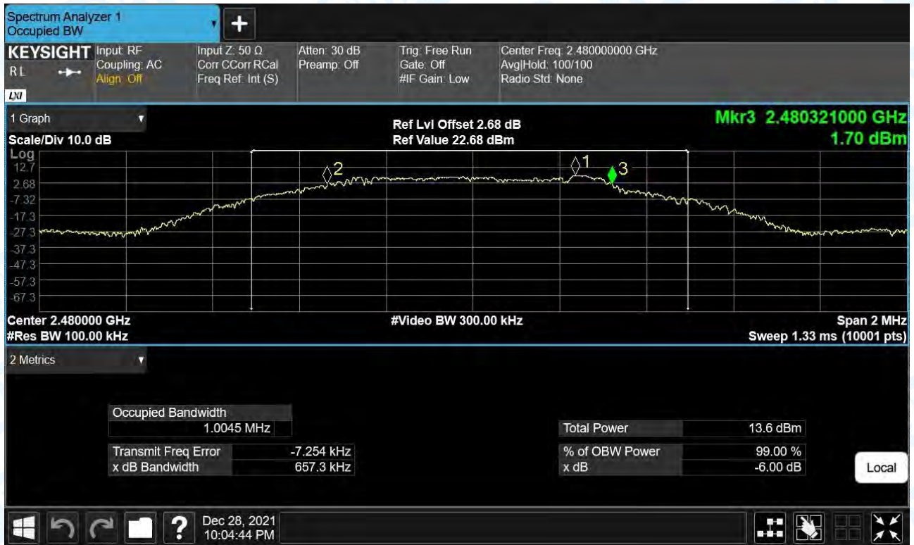
-6dB Bandwidth NVNT BLE 2Mbps 2402MHz Ant1
