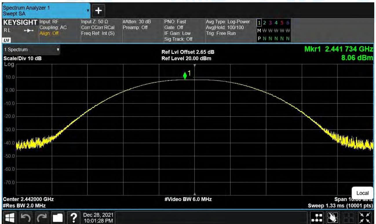
Power NVNT BLE 1Mbps 2442MHz Ant1
