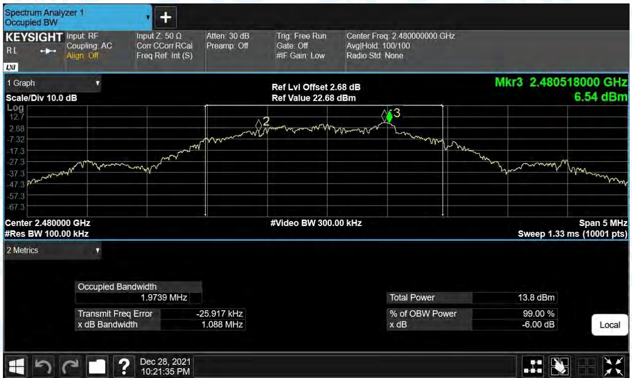
-6dB Bandwidth NVNT BLE 2Mbps 2480MHz Ant1
