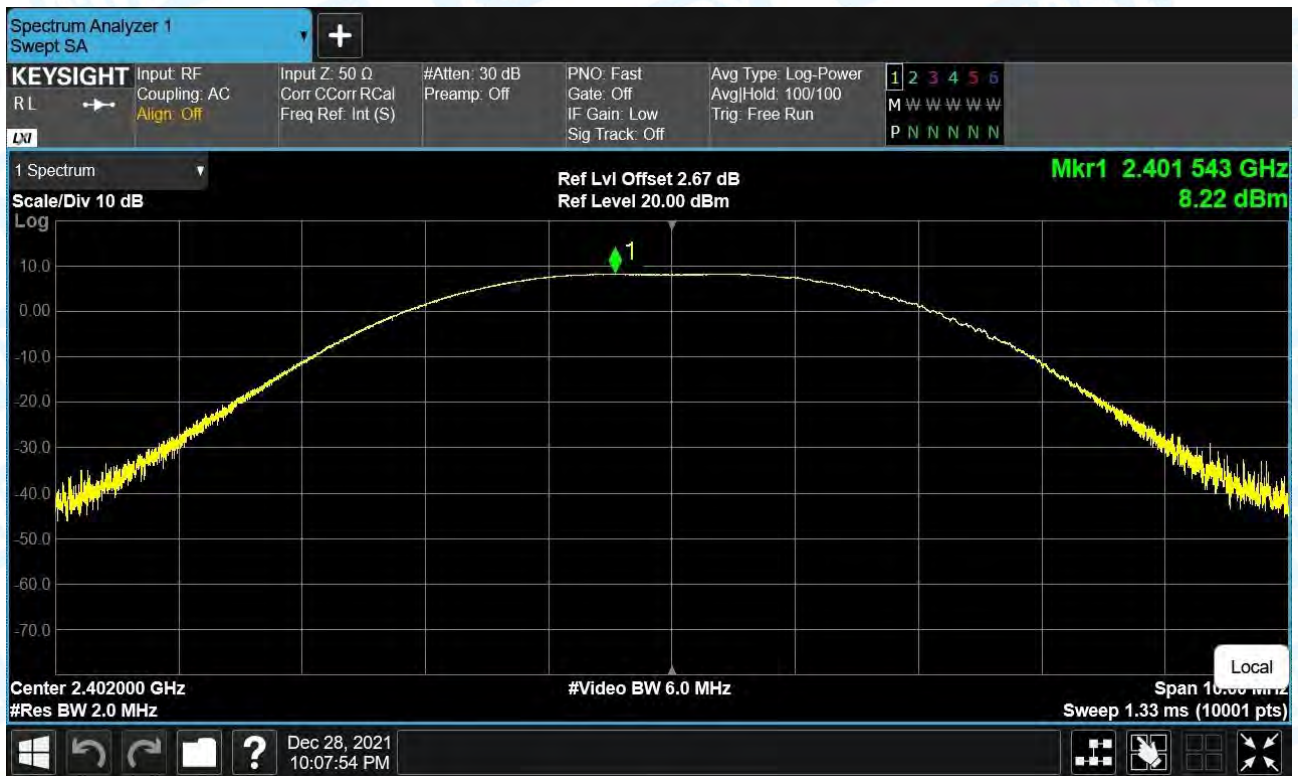
Power NVNT BLE 2Mbps 2402MHz Ant1
