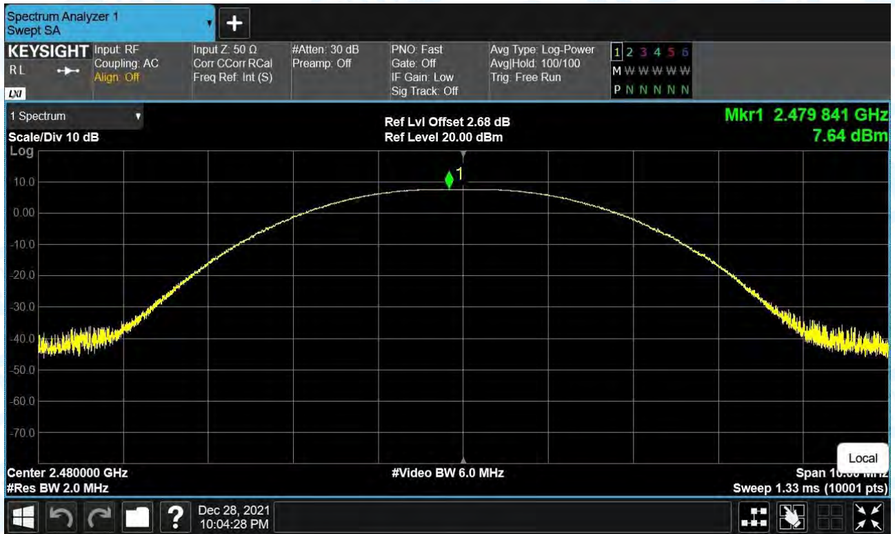
Power NVNT BLE 2Mbps 2402MHz Ant1
