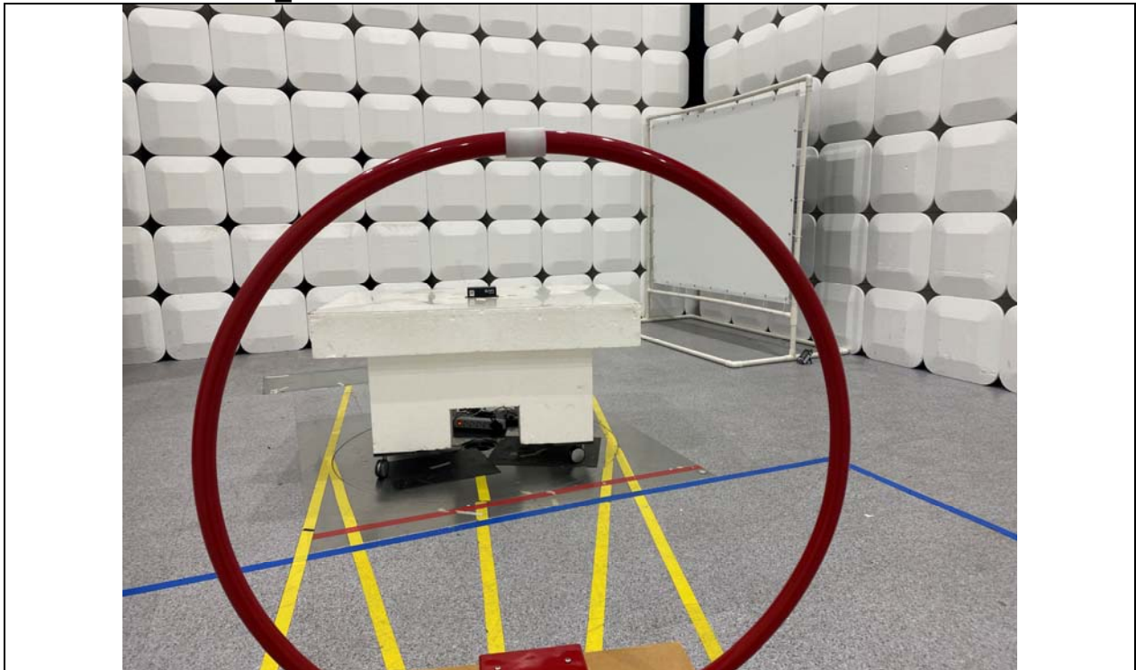
Test distance : 3 m, height of table : 0.8 m
