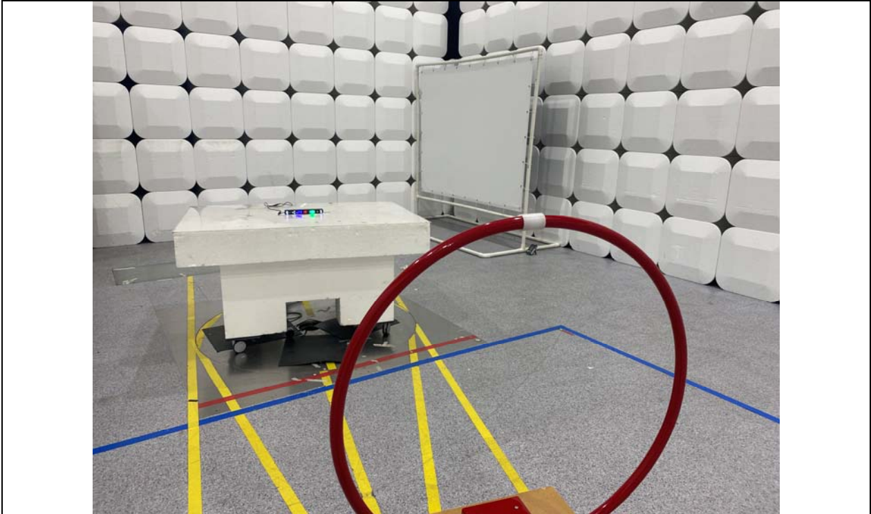
Test distance : 3 m, height of table : 0.8 m
