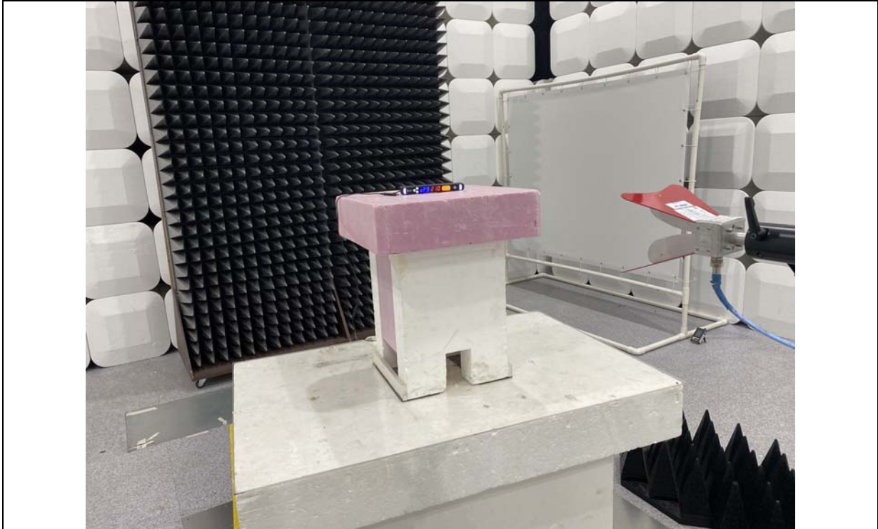
Test distance : 1 m, height of table : 1.5 m
