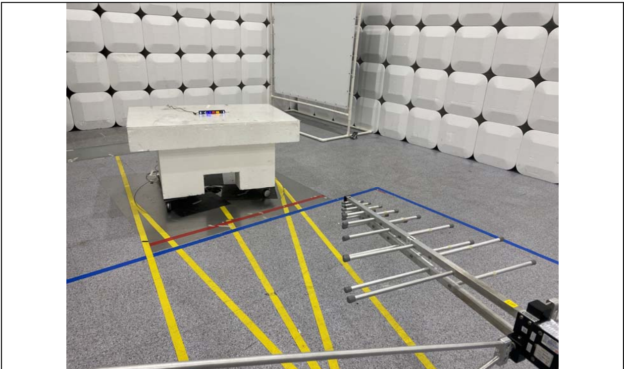
Test distance : 3 m, height of table : 0.8 m
