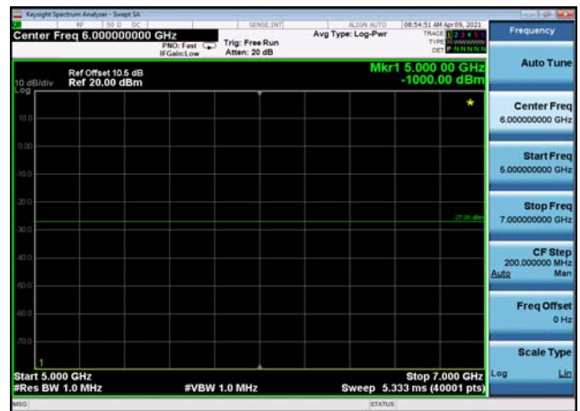
U-NII-3 ,Plot 3,5000MHz~7000MHz-802.1 1a(20MHz),5785MHz,Ant0
