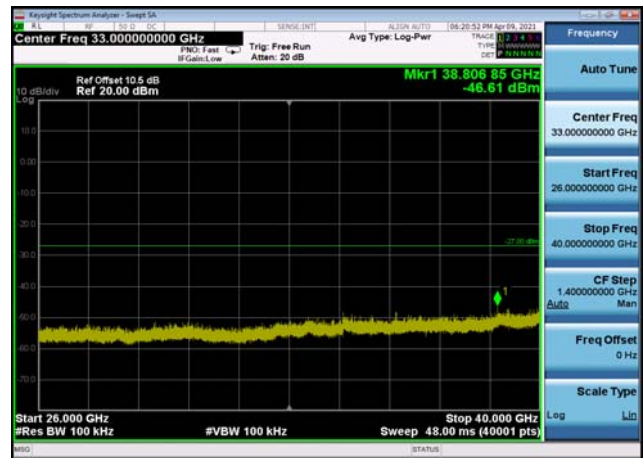
U-NII-3 ,Plot 2,26000MHz~40000MHz-802 .11n(20MHz),5825MHz,Ant1
