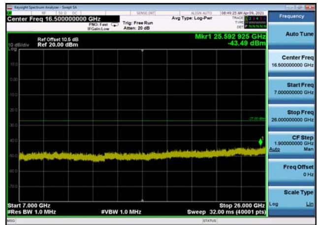
U-NII-3 ,Plot 4,7000MHz~26000MHz-802. 11a(20MHz),5825MHz,Ant0
