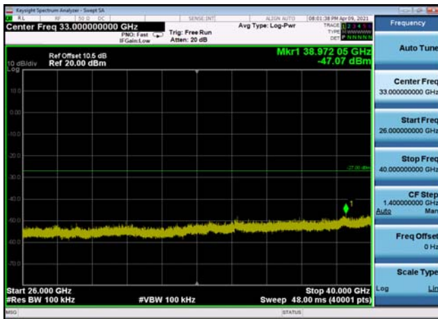
U-NII-3 ,Plot 2,26000MHz~40000MHz-802 .11ac(80MHz),5775MHz,Ant0
