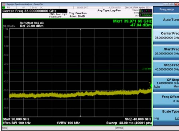
U-NII-3 ,Plot 2,26000MHz~40000MHz-802 .11ac(80MHz),5775MHz,Ant1
