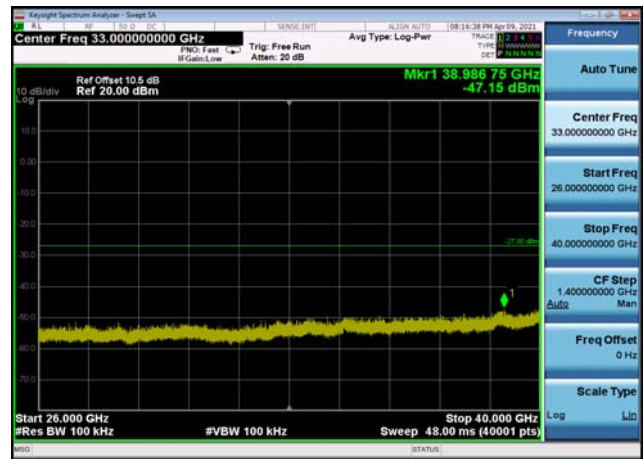
U-NII-3 ,Plot 2,26000MHz~40000MHz-802 .11ac(40MHz),5755MHz,Ant0
