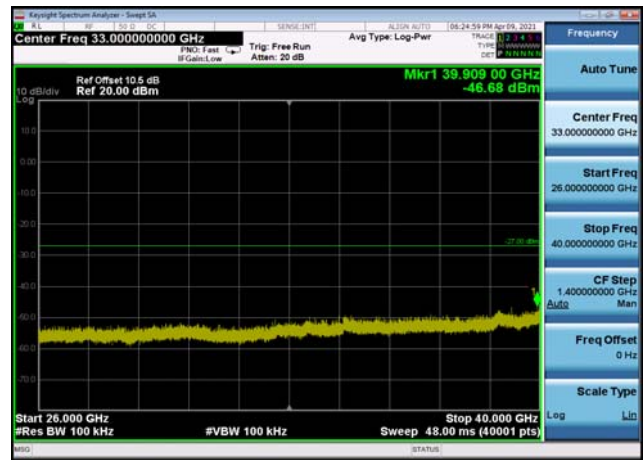
U-NII-3 ,Plot 2,26000MHz~40000MHz-802 .11ac(40MHz),5755MHz,Ant1
