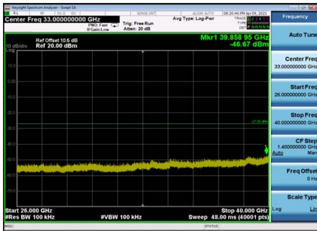
U-NII-3 ,Plot 2,26000MHz~40000MHz-802 .11ac(20MHz),5745MHz,Ant0
