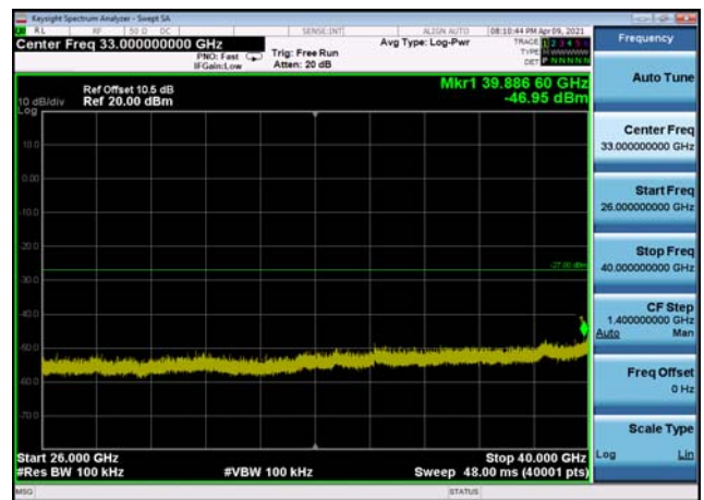
U-NII-3 ,Plot 2,26000MHz~40000MHz-802 .11n(20MHz),5825MHz,Ant0
