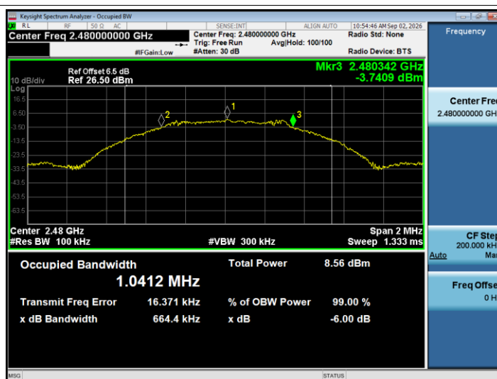
-6dB Bandwidth NVNT BLE 1M 2480MHz Ant1
