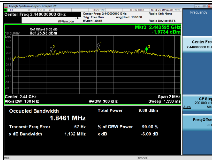
-6dB Bandwidth NVNT BLE 2M 2440MHz Ant1
