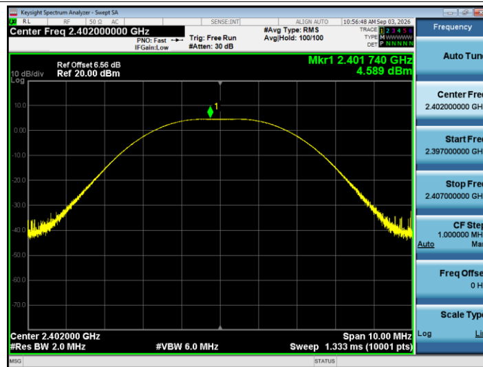
Peak Power NVNT BLE 2M 2402MHz Ant1
