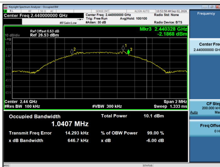
-6dB Bandwidth NVNT BLE 1M 2440MHz Ant1
