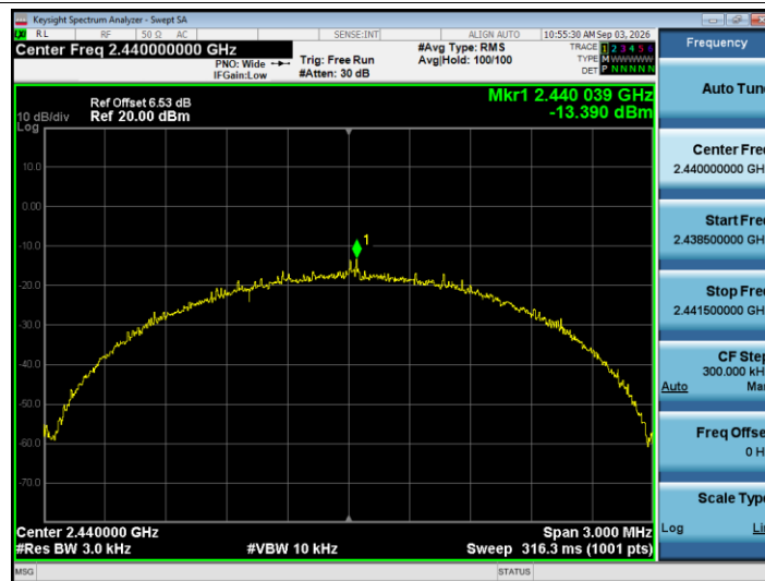
PSD NVNT BLE 2M 2440MHz Ant1
