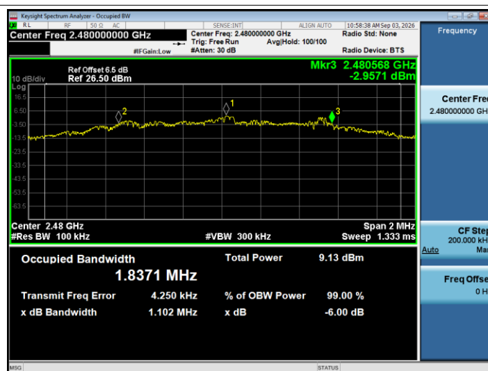
-6dB Bandwidth NVNT BLE 2M 2480MHz Ant1
