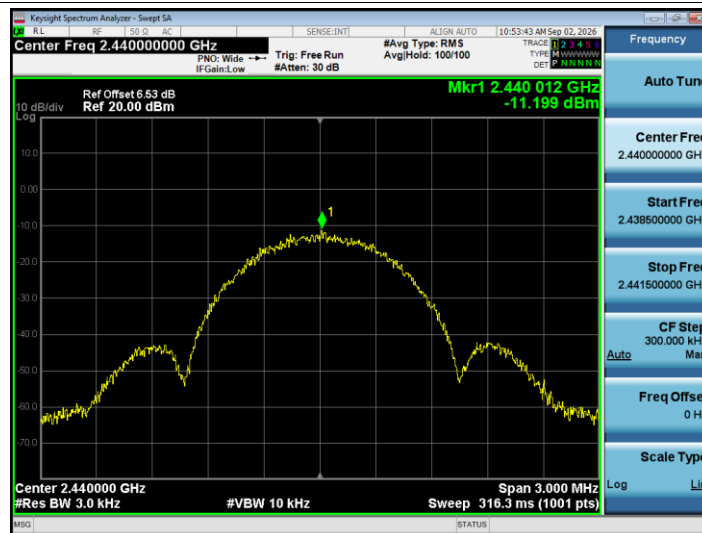
PSD NVNT BLE 1M 2440MHz Ant1
