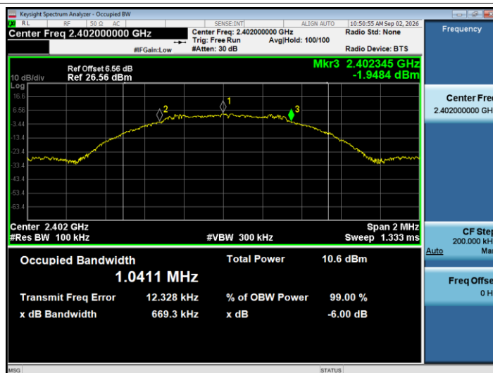
-6dB Bandwidth NVNT BLE 1M 2402MHz Ant1
