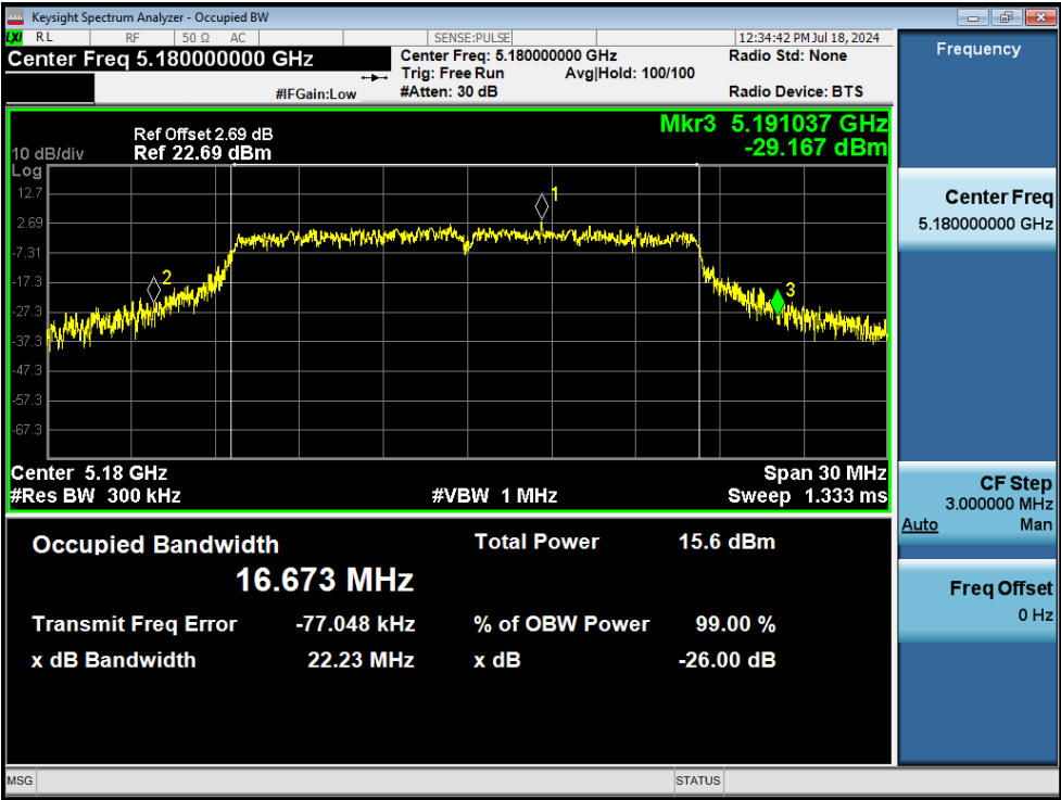
-26dB Bandwidth NVNT a 5180MHz Ant1
