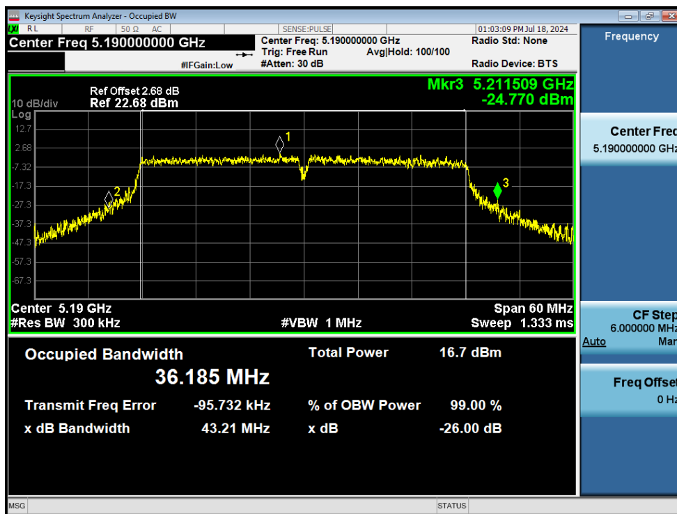
-26dB Bandwidth NVNT n40 5190MHz Ant1
