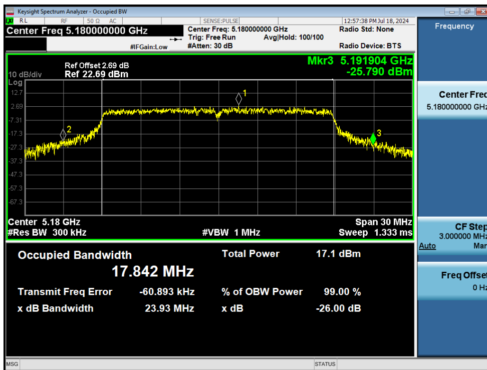
-26dB Bandwidth NVNT ac20 5180MHz Ant1
