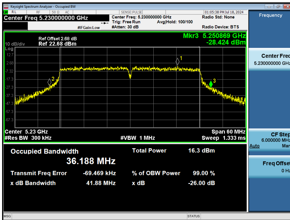
-26dB Bandwidth NVNT n40 5230MHz Ant1
