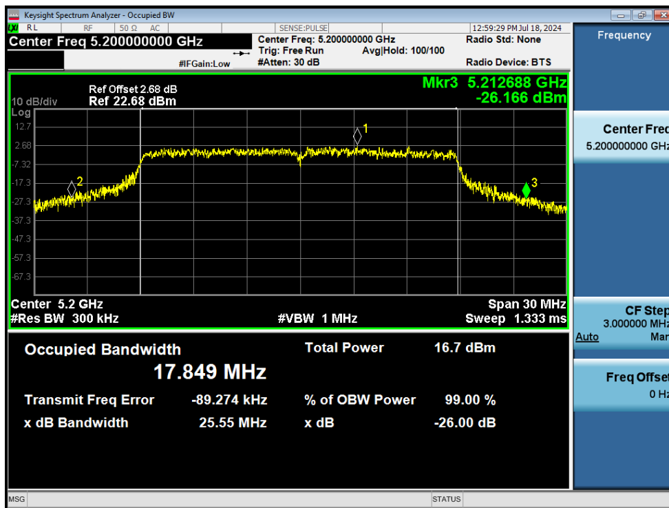
-26dB Bandwidth NVNT ac20 5200MHz Ant1
