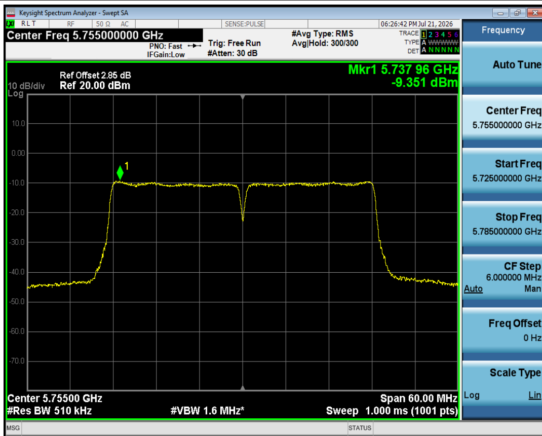
PSD NVNT ac40 5755MHz Ant1
