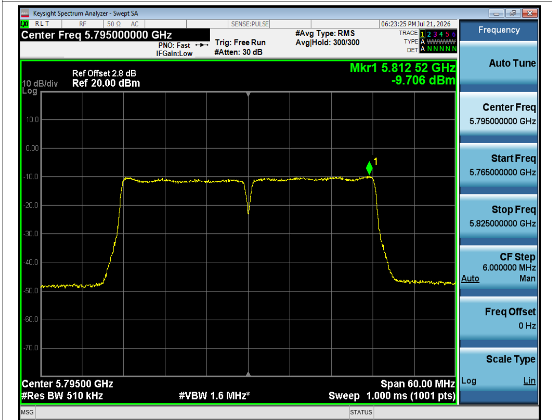
PSD NVNT n40 5795MHz Ant1
