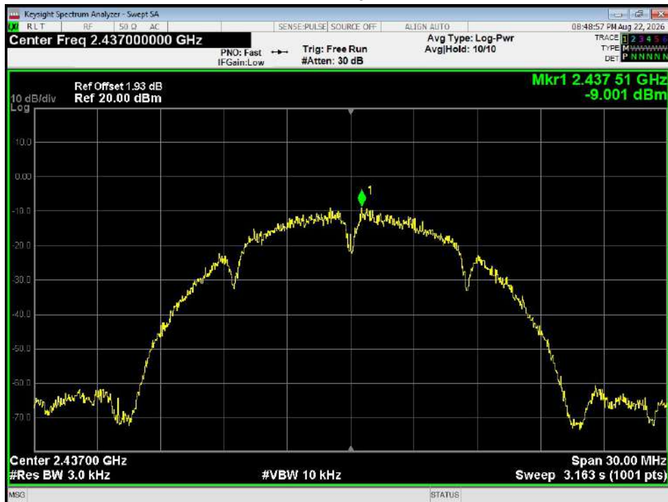
PSD NVNT b 2437MHz Ant1
