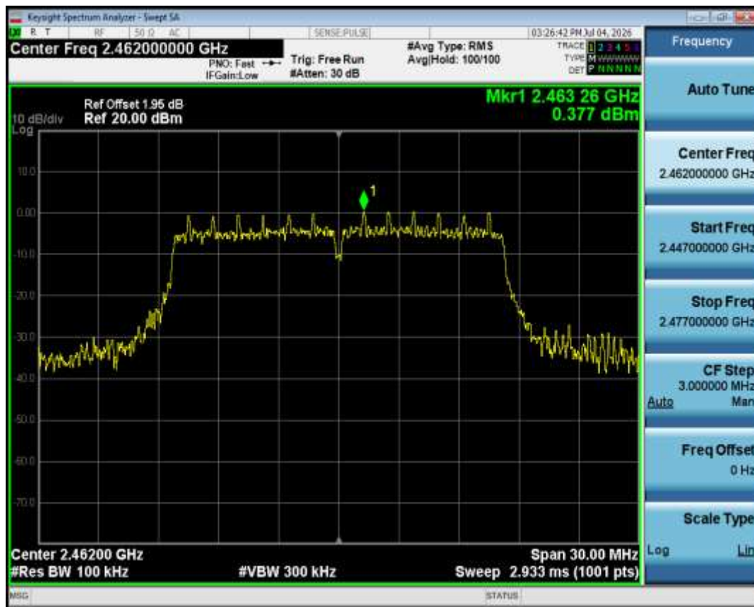
Band Edge NVNT g 2462MHz Ant1 Ref
