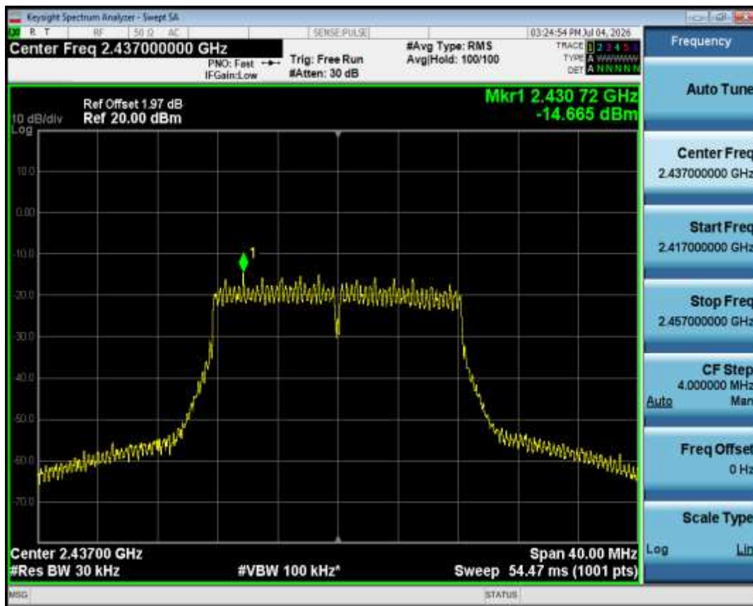
PSD NVNT g 2437MHz Ant1
