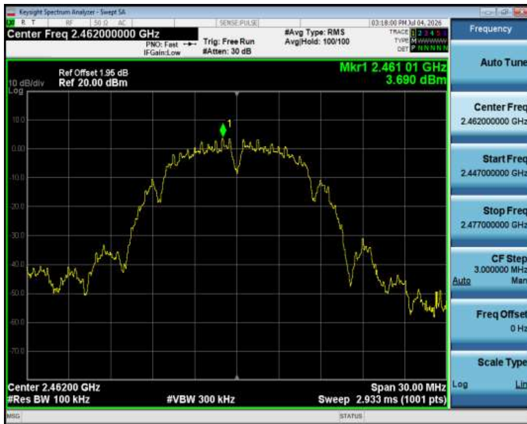
Band Edge NVNT b 2462MHz Ant1 Ref
