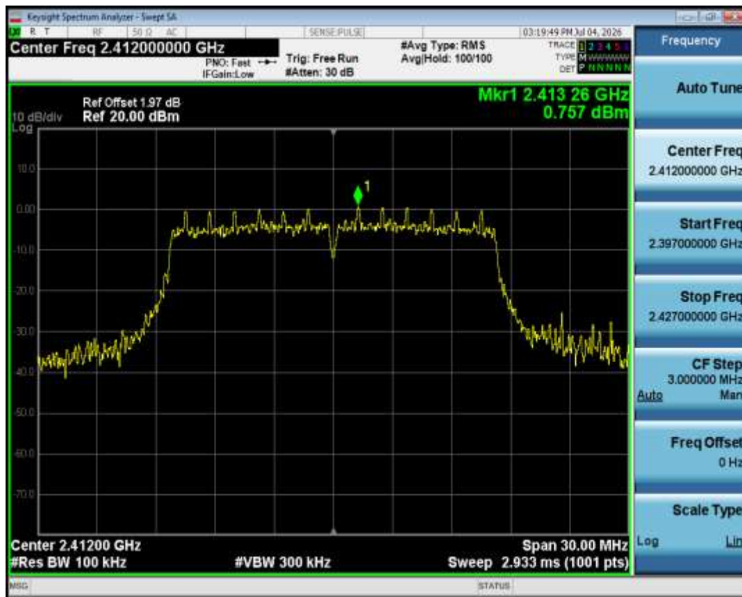
Band Edge NVNT g 2412MHz Ant1 Ref
