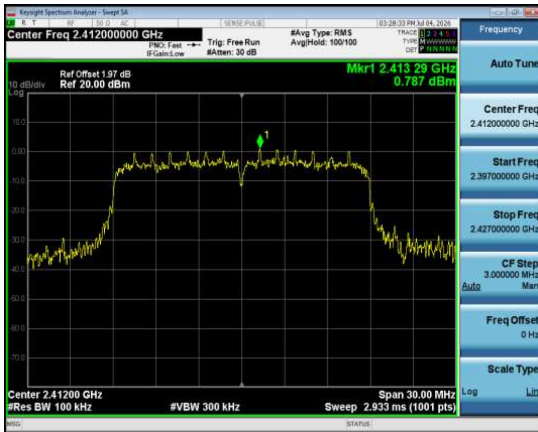
Band Edge NVNT n20 2412MHz Ant1 Ref
