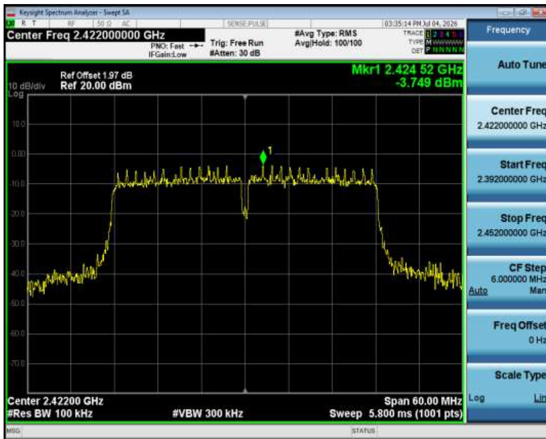
Band Edge NVNT n40 2422MHz Ant1 Ref
