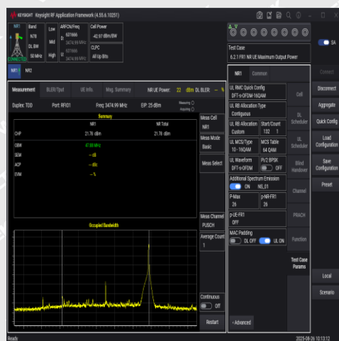
NTNV-N78-3450-3550-PC2-30-50-L-DFT-16QAM- Edge 1RB Right-PASS
