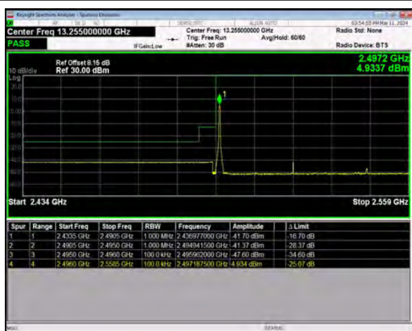
n41 SCS=30kHz DFT_256QAM BW=50MHz
