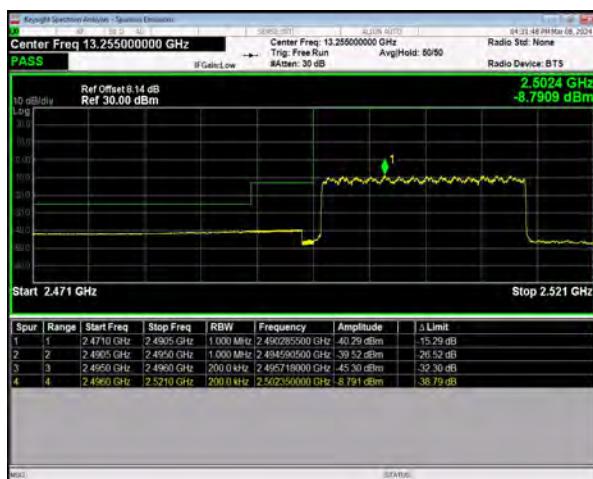
n41 SCS=30kHz DFT_256QAM BW=20MHz
