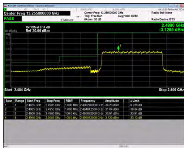
n41 SCS=30kHz DFT_QPSK BW=10MHz LowChannel=500202 RB=24@0
