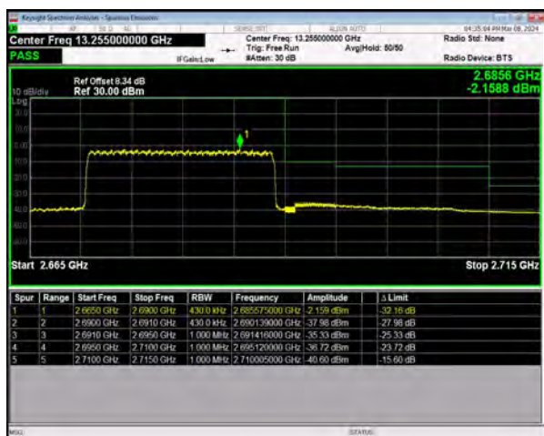
n41 SCS=30kHz DFT_QPSK BW=20MHz HighChannel=535998 RB=50@0
