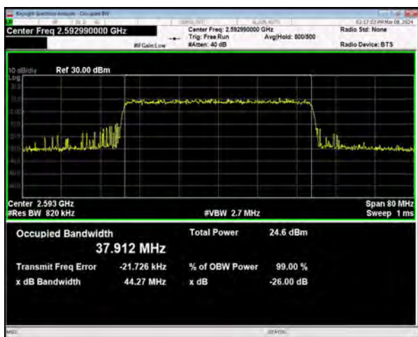
n41 SCS=30kHz CP_256QAM BW=40MHz Channel=518598 RB=106@0
