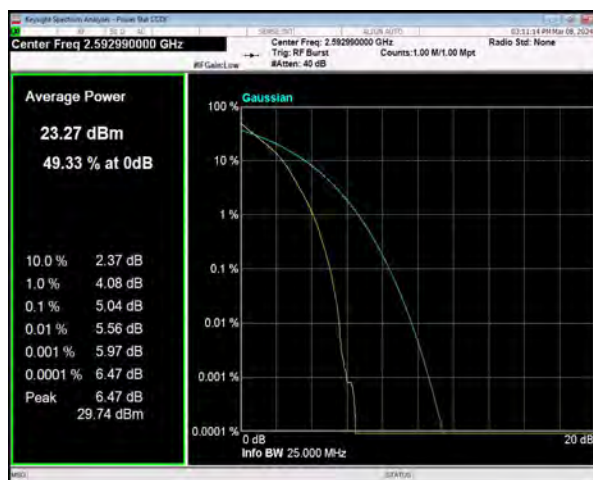
n41 SCS=30kHz DFT_QPSK BW=20MHz Channel=518598 RB=50@0
