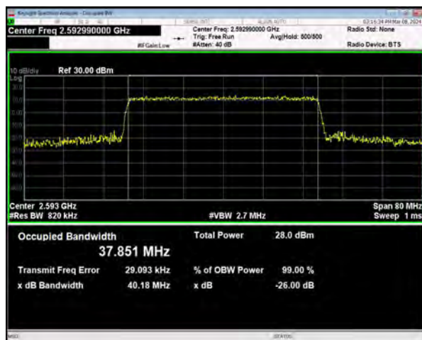
n41 SCS=30kHz CP_QPSK BW=40MHz Channel=518598 RB=106@0
