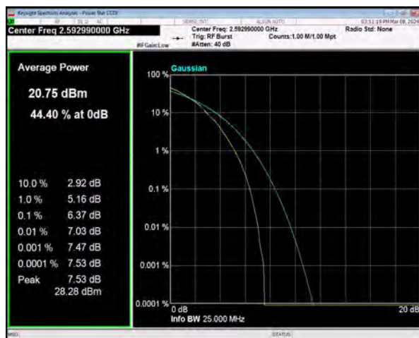
n41 SCS=30kHz DFT_64QAM BW=20MHz Channel=518598 RB=50@0
