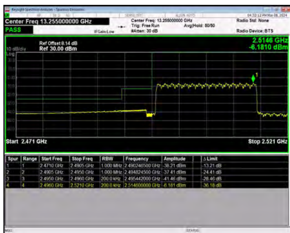
n41 SCS=30kHz CP_QPSK BW=20MHz LowChannel=501204 RB=51@0
