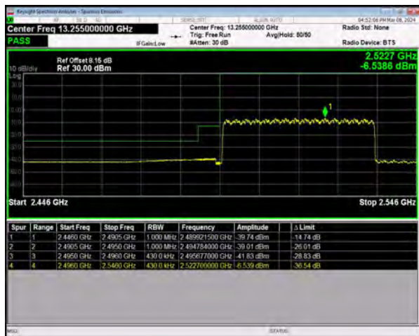
n41 SCS=30kHz CP_QPSK BW=40MHz LowChannel=503202 RB=106@0
