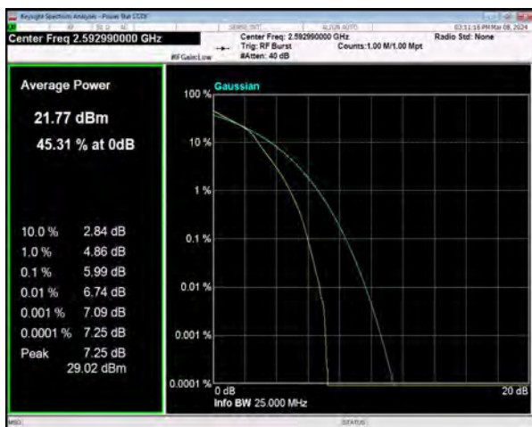
n41 SCS=30kHz DFT_16QAM BW=20MHz Channel=518598 RB=50@0
