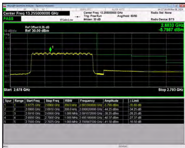
n41 SCS=30kHz DFT_256QAM BW=10MHz
