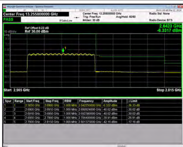
n41 SCS=30kHz DFT_16QAM BW=100MHz
