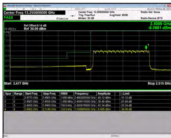
n41 SCS=30kHz DFT_256QAM BW=15MHz
