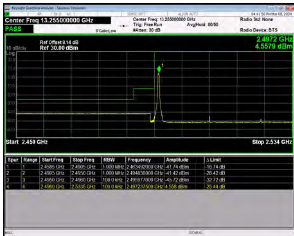
n41 SCS=30kHz DFT_256QAM BW=30MHz
