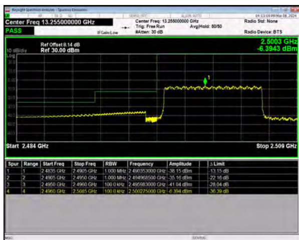
n41 SCS=30kHz CP_QPSK BW=10MHz LowChannel=500202 RB=24@0
