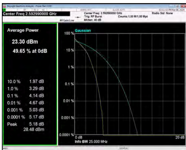
n41 SCS=30kHz DFT_BPSK BW=20MHz Channel=518598 RB=50@0
