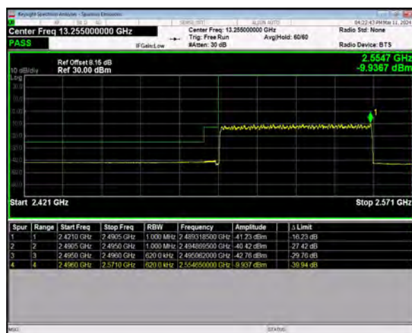
n41 SCS=30kHz DFT_256QAM BW=60MHz
