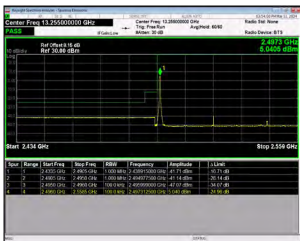
n41 SCS=30kHz DFT_64QAM BW=50MHz
