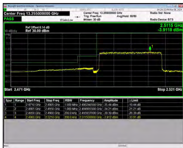
n41 SCS=30kHz DFT_QPSK BW=20MHz LowChannel=501204 RB=50@0
