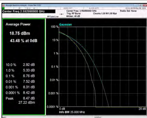
n41 SCS=30kHz DFT_256QAM BW=20MHz Channel=518598 RB=50@0
