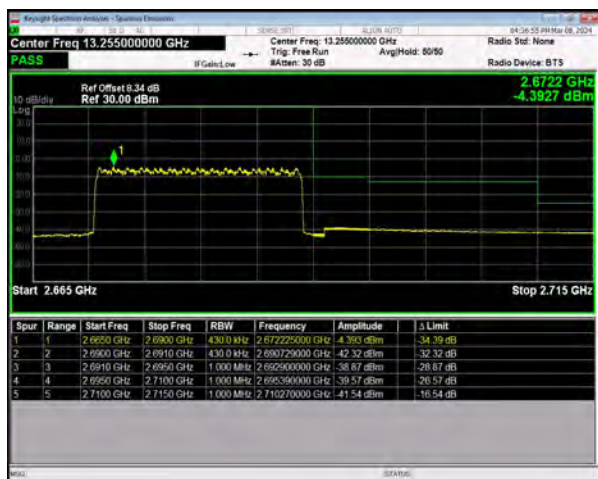
n41 SCS=30kHz DFT_64QAM BW=20MHz
