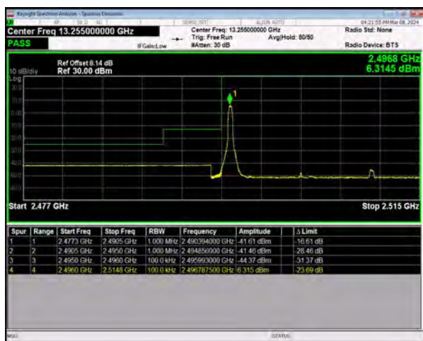
n41 SCS=30kHz DFT_256QAM BW=15MHz
