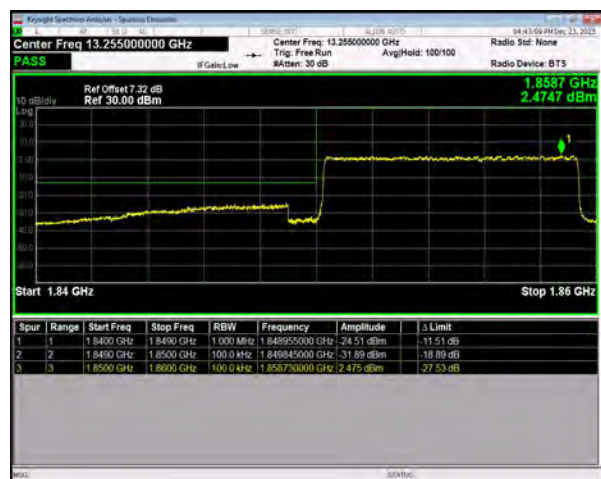
n25 SCS=15kHz DFT_64QAM BW=10MHz LowChannel=371000 RB=50@0
