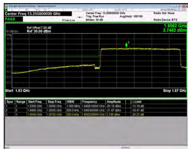
n25 SCS=15kHz DFT_16QAM BW=20MHz LowChannel=372000 RB=100@0
