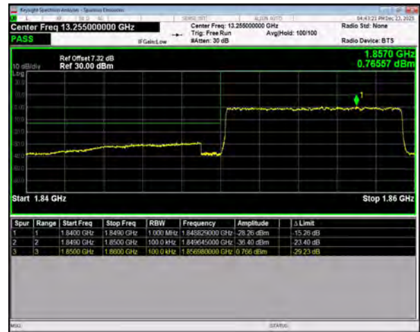
n25 SCS=15kHz DFT_256QAM BW=10MHz LowChannel=371000 RB=50@0
