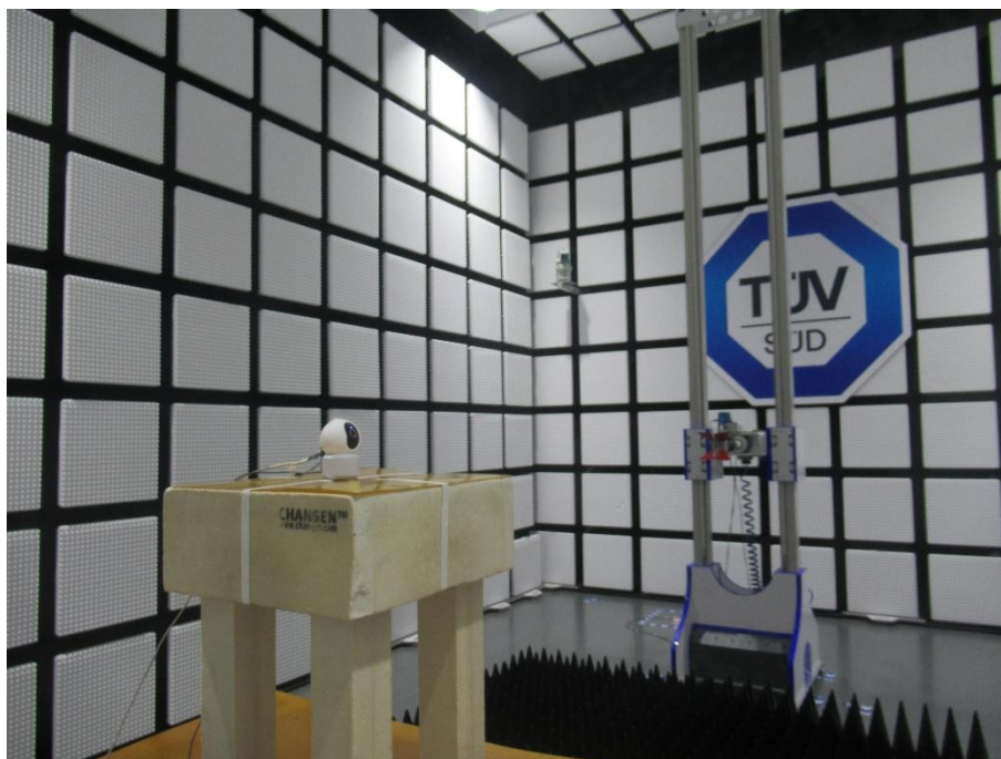
1GHz-18GHz RSE Setup
