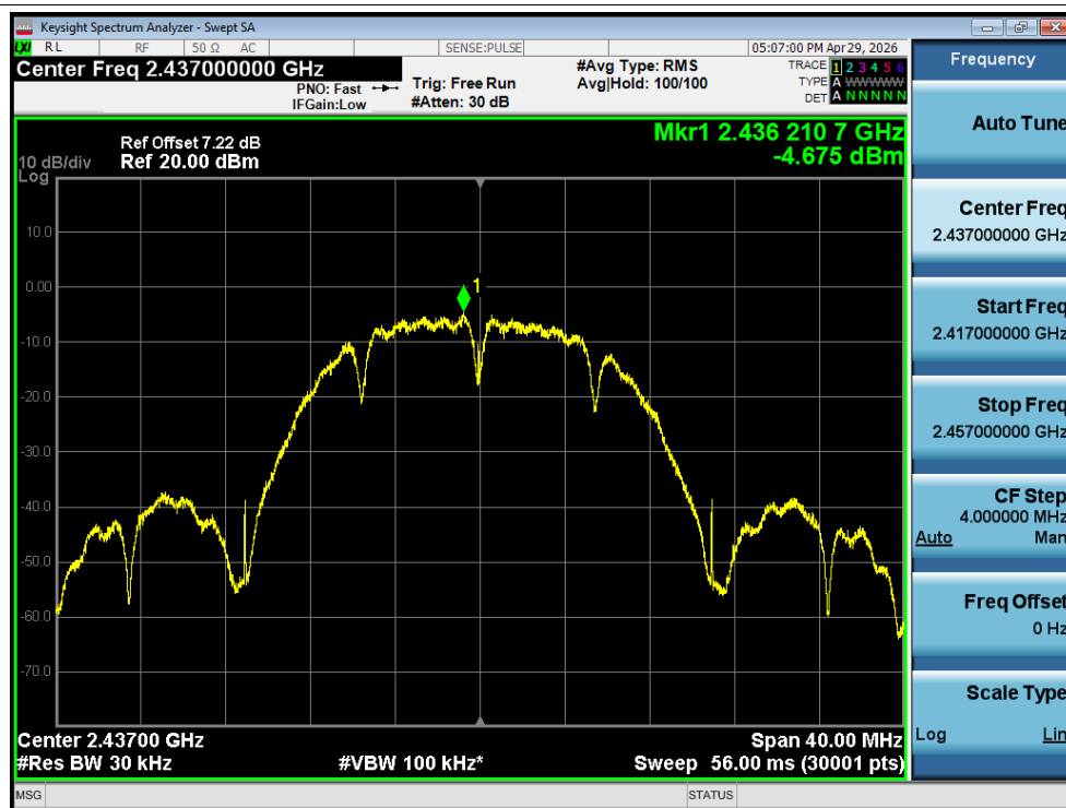
PSD NVNT b 2437MHz Ant1
