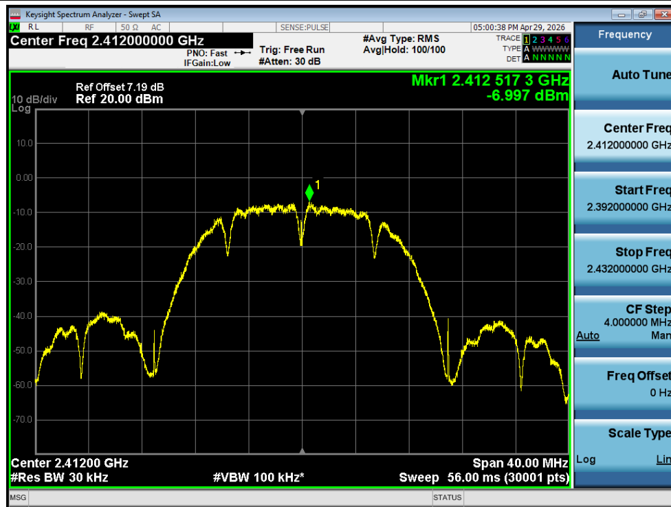
PSD NVNT b 2412MHz Ant1
