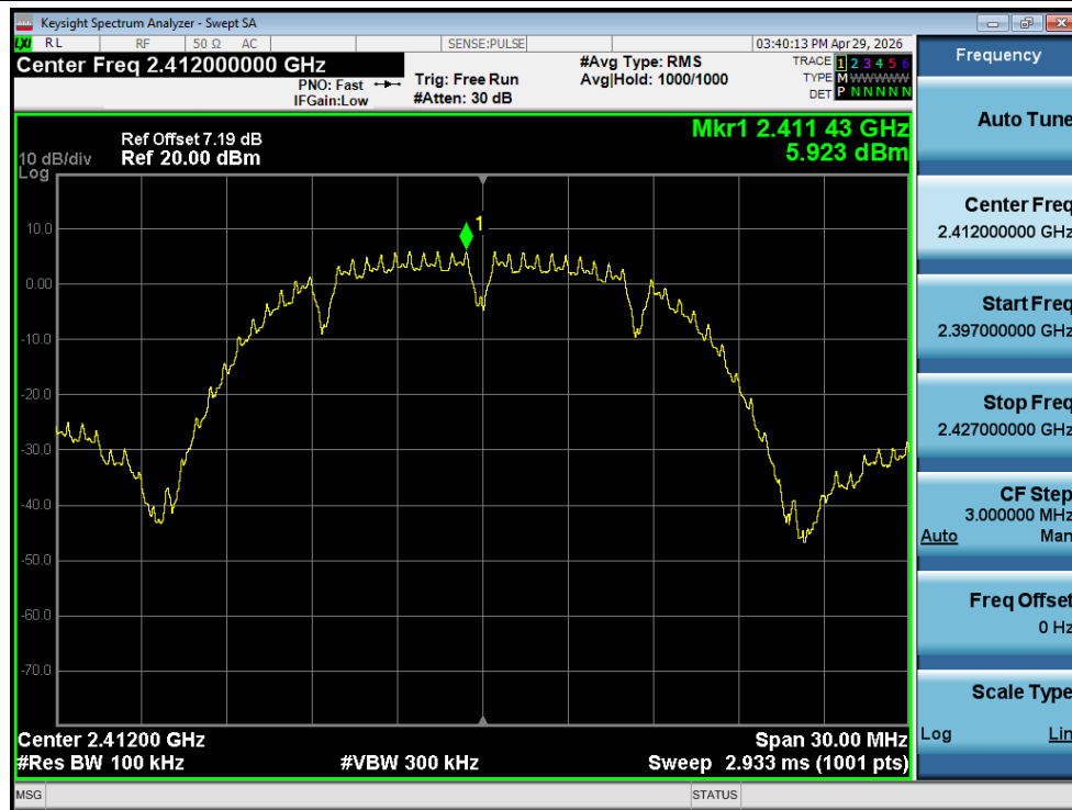
Band Edge NVNT b 2412MHz Ant1 Ref
