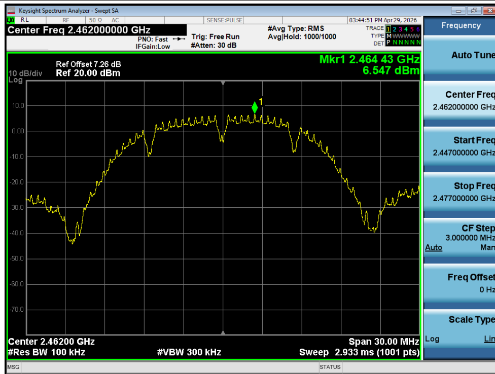
Band Edge NVNT b 2462MHz Ant1 Ref
