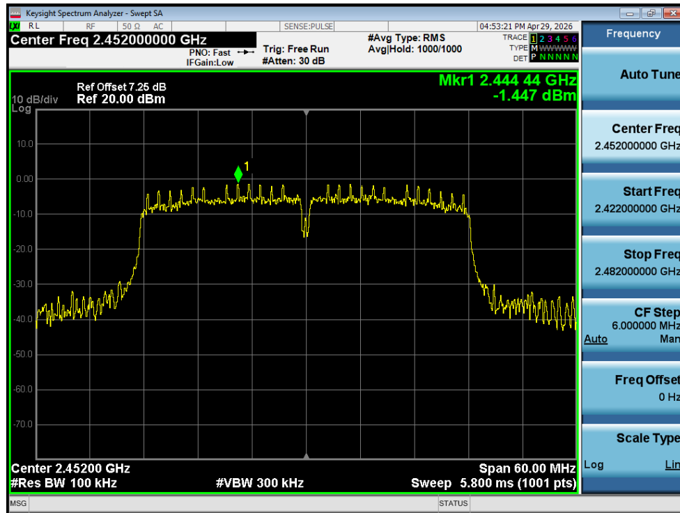
Band Edge NVNT n40 2452MHz Ant1 Ref
