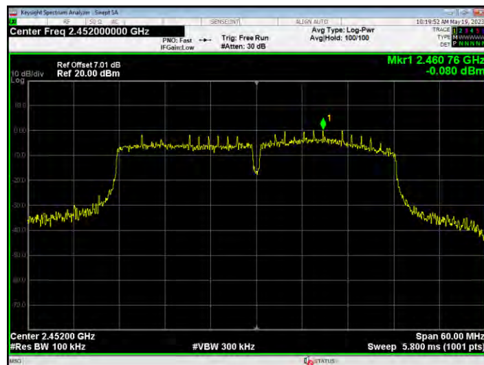
Band Edge NVNT n40 2452MHz Ant1 Ref
