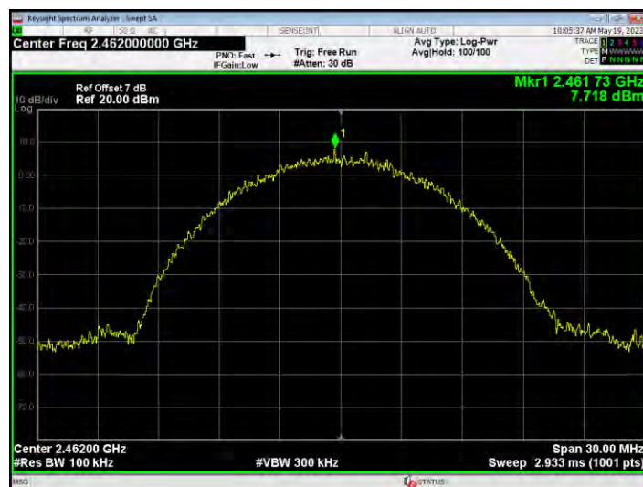
Band Edge NVNT b 2462MHz Ant1 Ref
