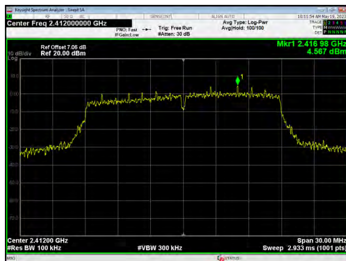
Band Edge NVNT n20 2412MHz Ant1 Ref
