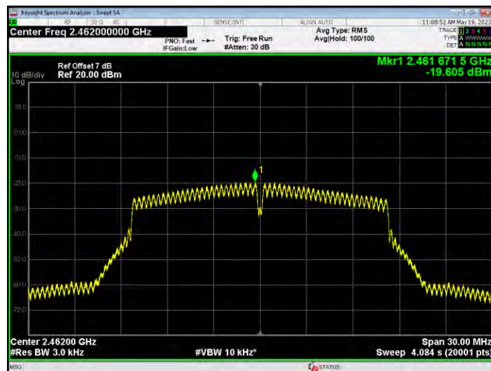
PSD NVNT g 2462MHz Ant1
