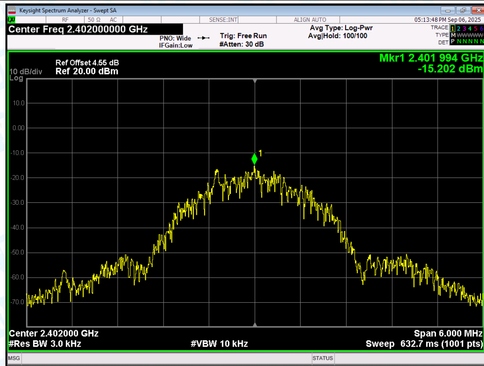
PSD NVNT BLE 2Mbps 2402MHz Ant1
