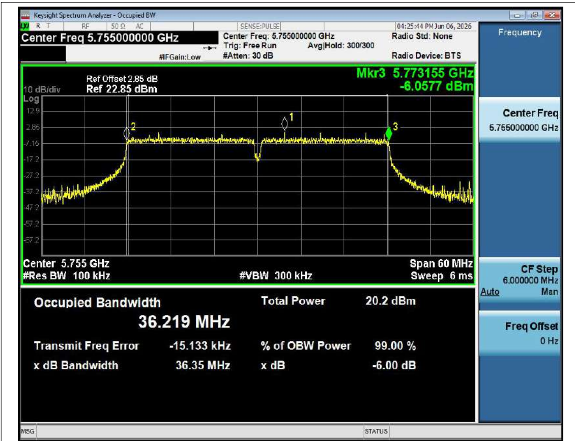
-6dB Bandwidth NVNT n40 5755MHz Ant1
