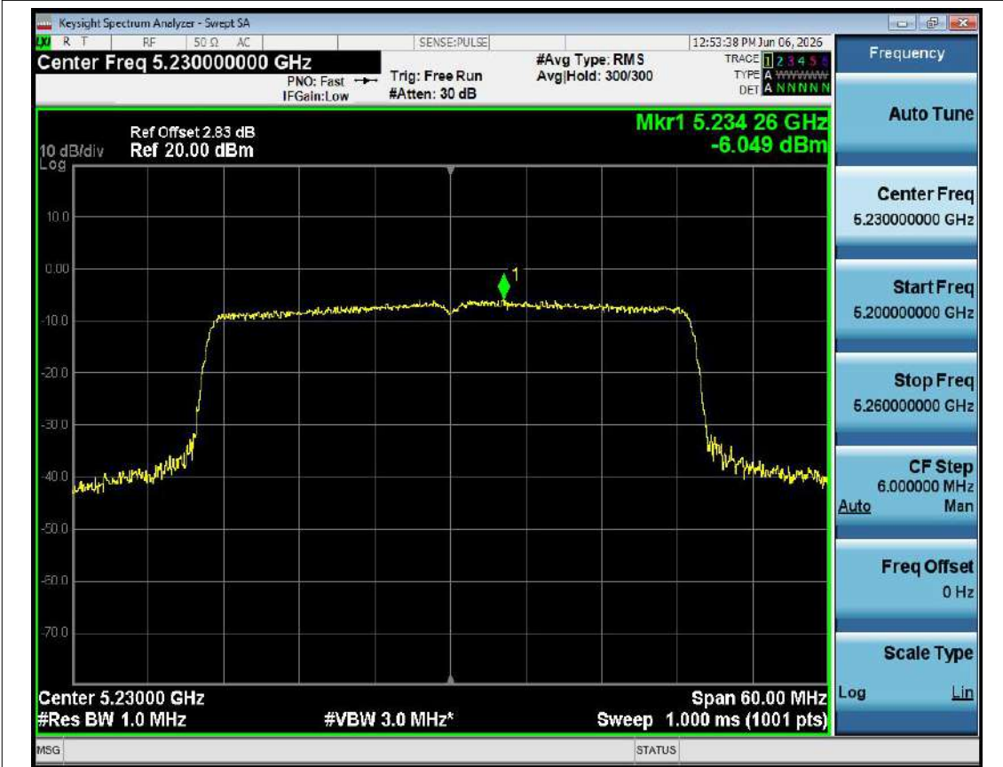
PSD NVNT ax40 5230MHz Ant1
