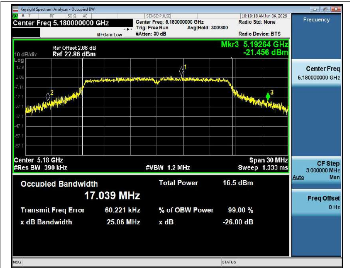
-26dB Bandwidth NVNT a 5180MHz Ant1
