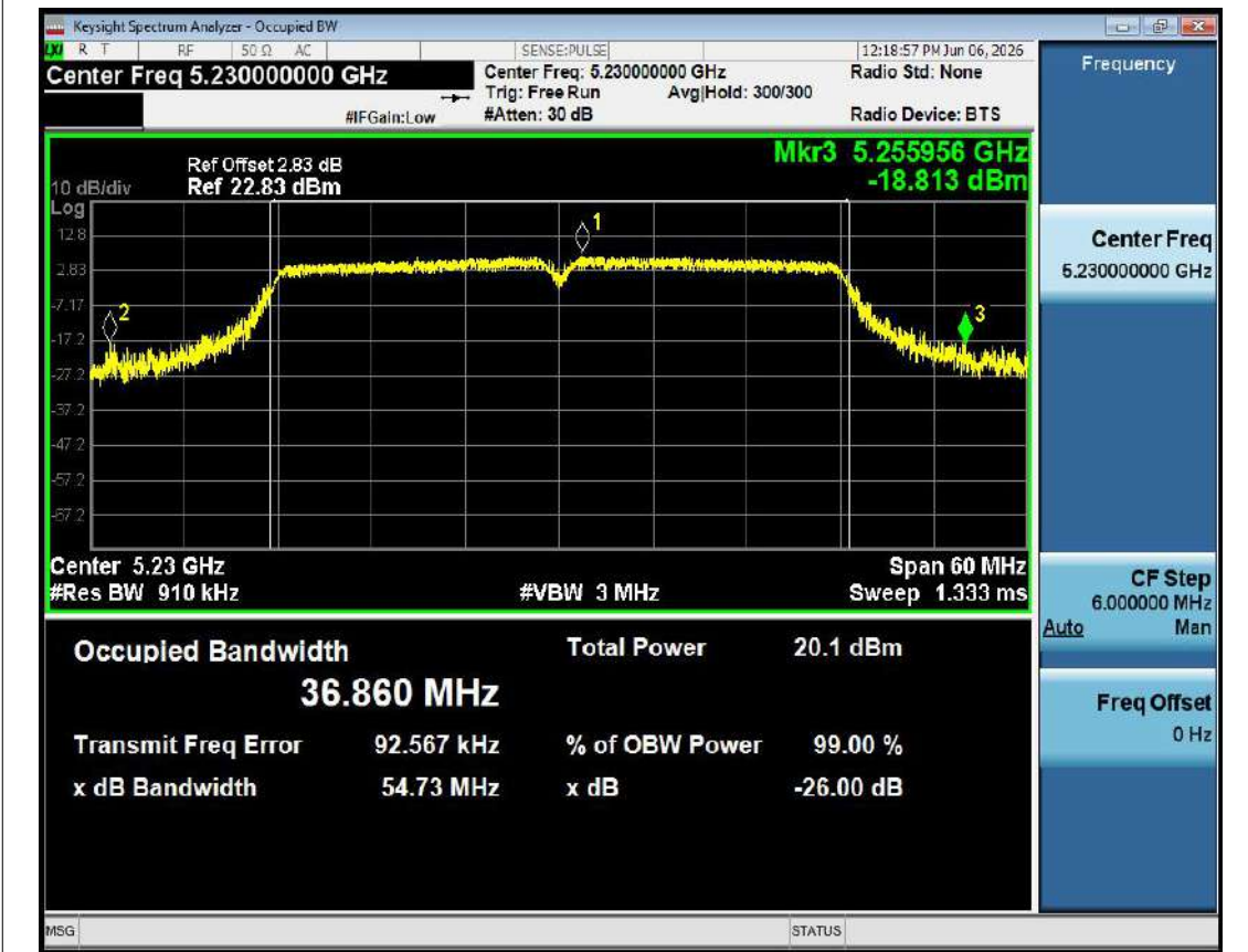
-26dB Bandwidth NVNT n40 5230MHz Ant1
