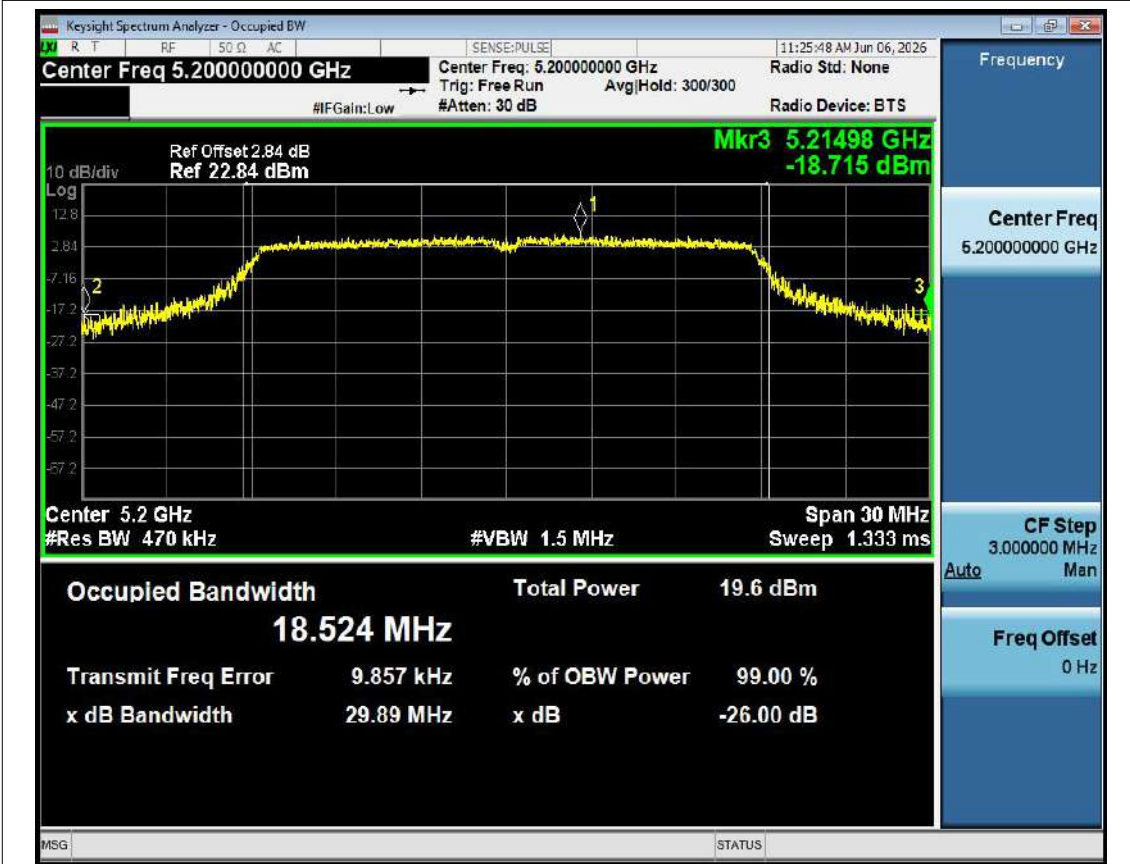
-26dB Bandwidth NVNT ac20 5200MHz Ant1
