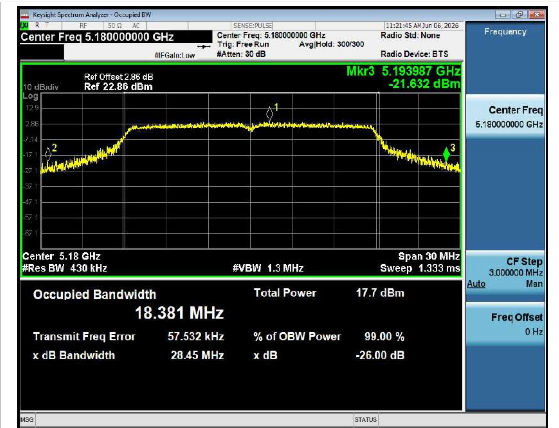
-26dB Bandwidth NVNT ac20 5180MHz Ant1
