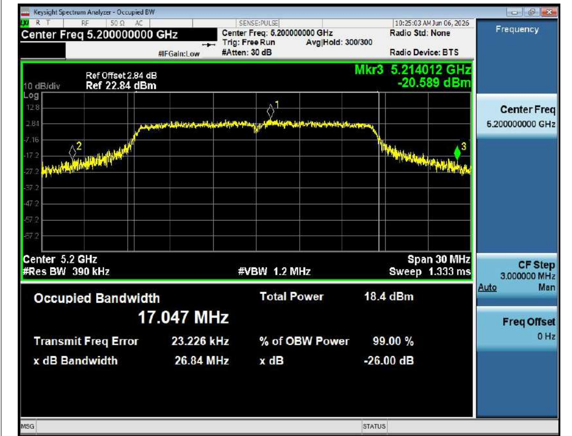
-26dB Bandwidth NVNT a 5200MHz Ant1
