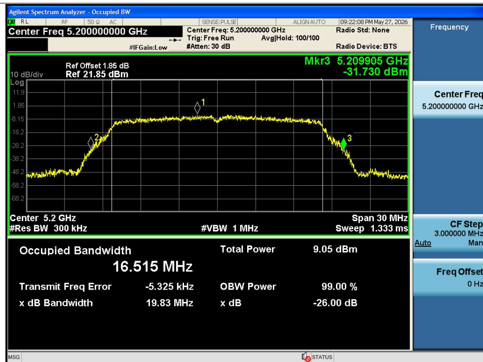
-26dB Bandwidth NVNT a 5200MHz Ant1
