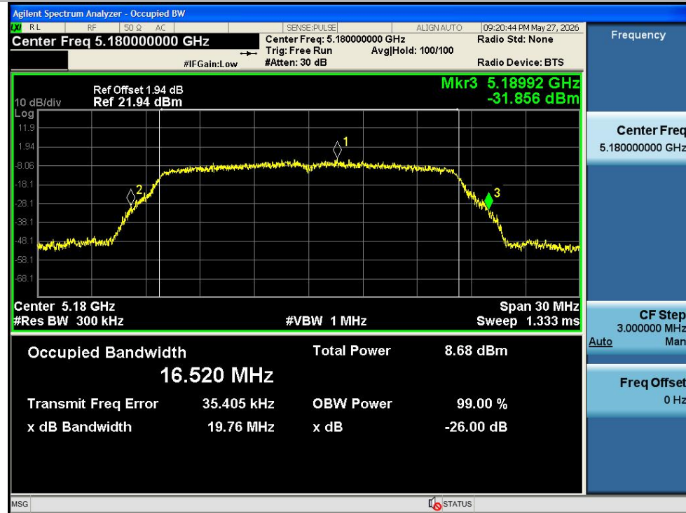
-26dB Bandwidth NVNT a 5200MHz Ant1
