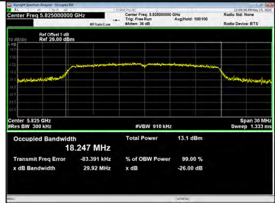
IEEE 802.11n_Channel 165_20MHz_Antenna 0
