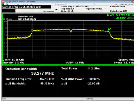
IEEE 802.11n_Channel 151_40MHz_Antenna 0
