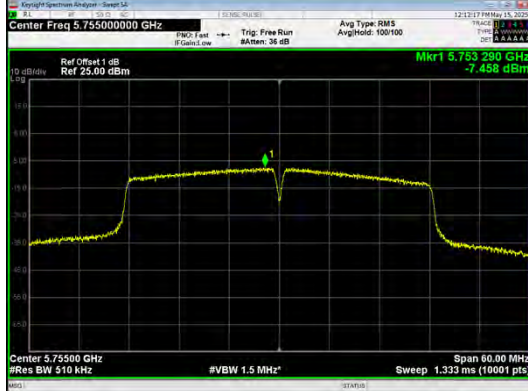
IEEE 802.11n_Channel 151_40MHz_Antenna 0
