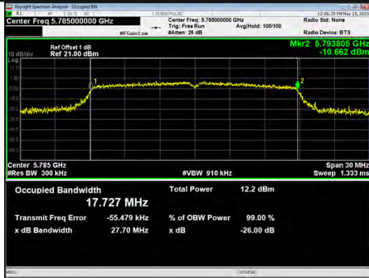
IEEE 802.11n_Channel 157_20MHz_Antenna 0
