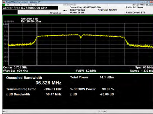
IEEE 802.11n_Channel 151_40MHz_Antenna 0
