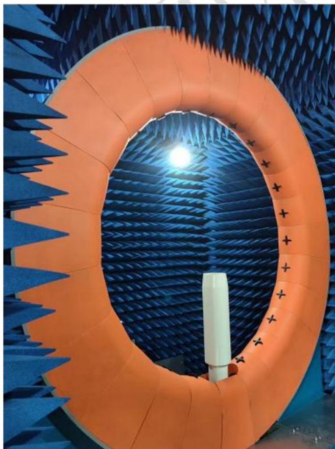
24 探头微波暗室测试设备
