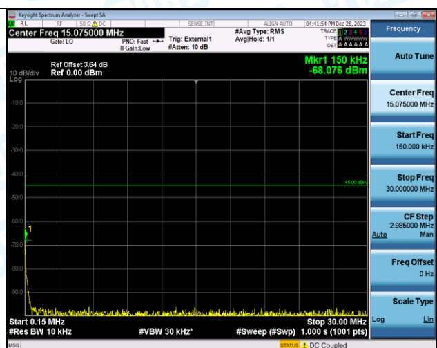
Band41 15MHz QPSK 39725 1RB#0 1000~20000 1000~20000
