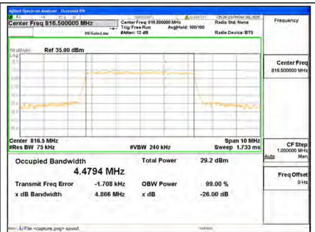
B26 Part90 / 5MHz / 16QAM/ Low CH
