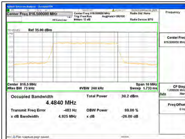
B26 Part90 / 5MHz / QPSK/ Low CH
