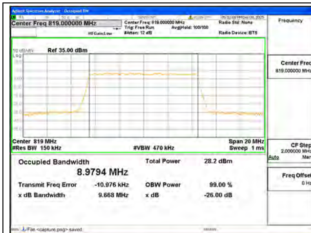
B26 Part90 / 10MHz / 64QAM/ Mid CH
