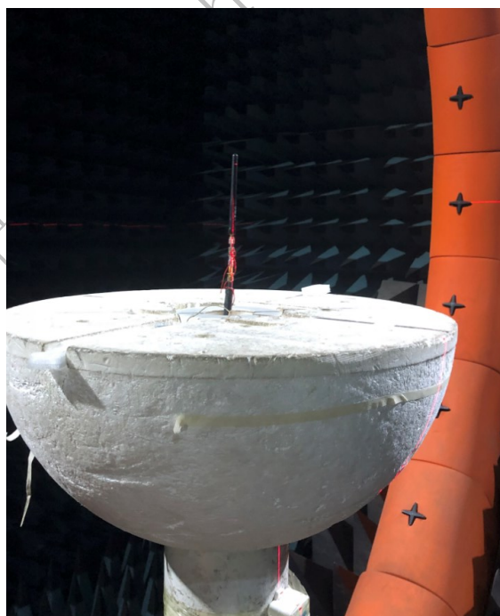
The production test position/天线测试放置位置
