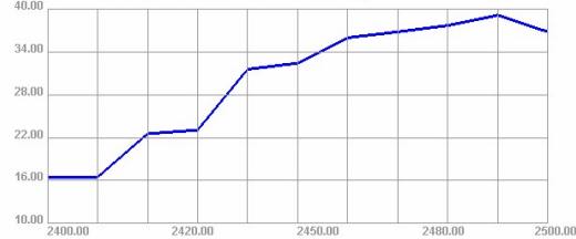
2400.00MHz - 2500.00MHz Efficiency
