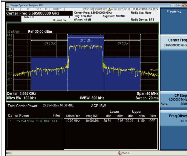
Band48-10MHz-QPSK-56690-50RB#0-PASS
