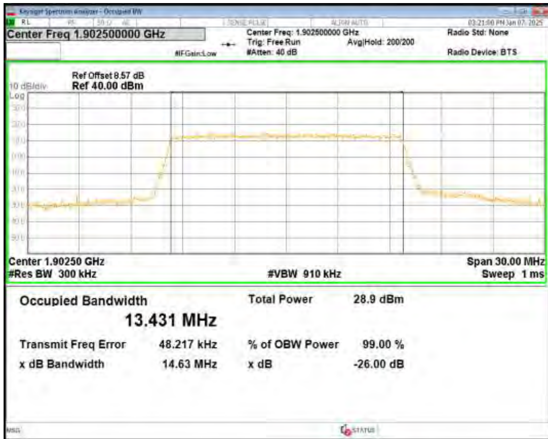
Band2 QPSK BW=20MHz Channel=18700 RB Size=100 Position=#0
