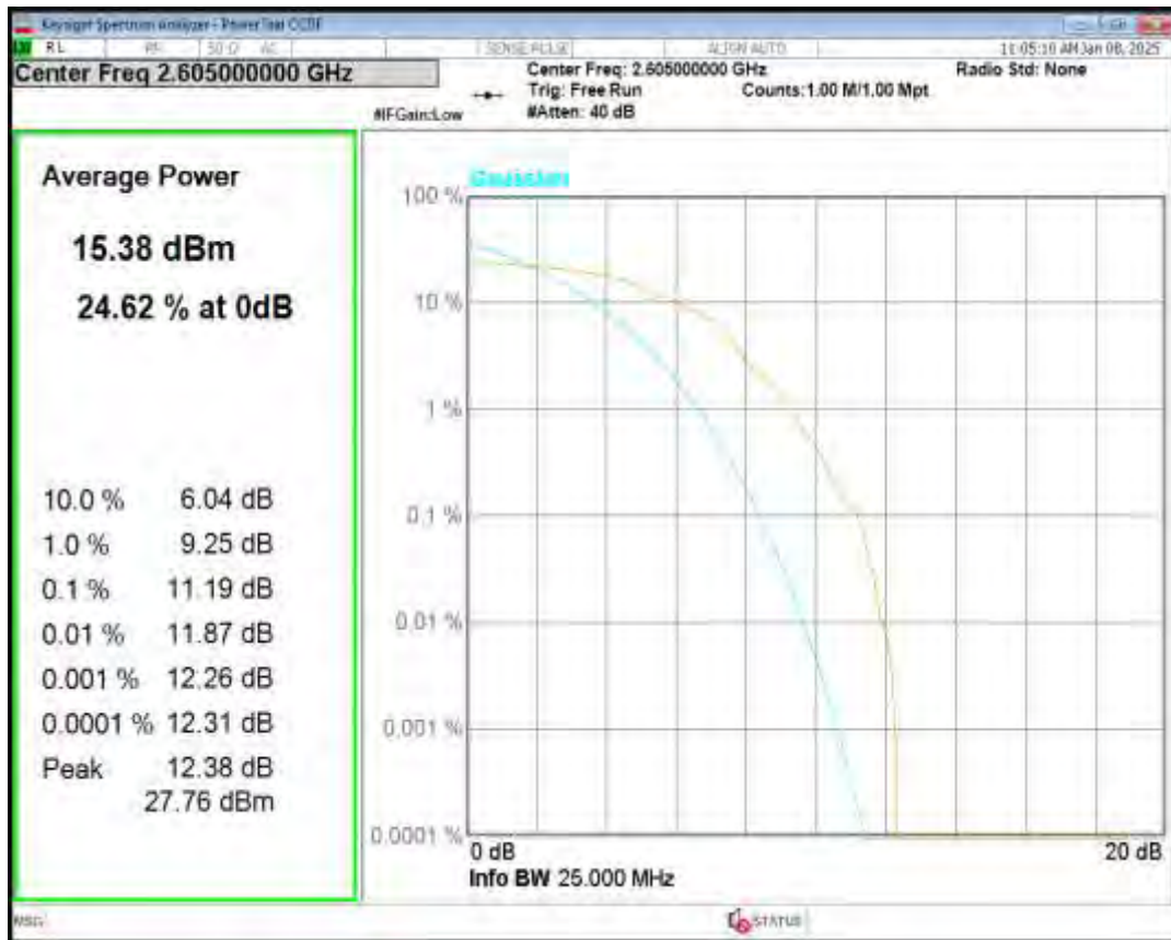
Band41(2555-2655) QPSK BW=10MHz Channel=40290 RB Size=1 Position=#0
