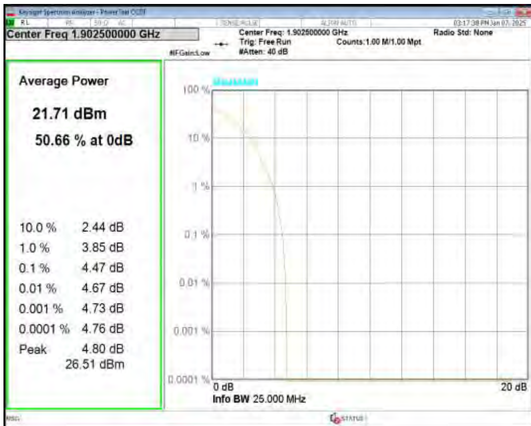
Band2 QPSK BW=20MHz Channel=18700 RB Size=1 Position=#0
