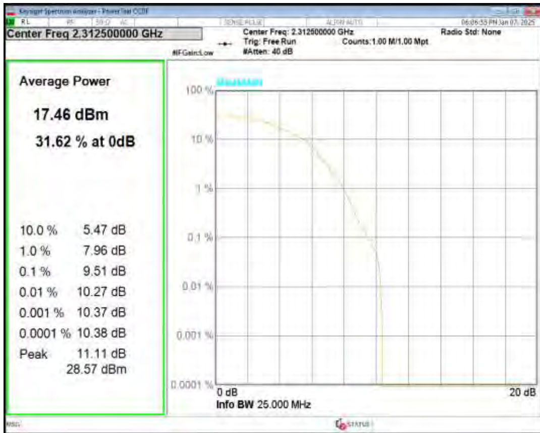
Band40(2305-2315) QPSK BW=10MHz Channel=38750 RB Size=1 Position=#0
