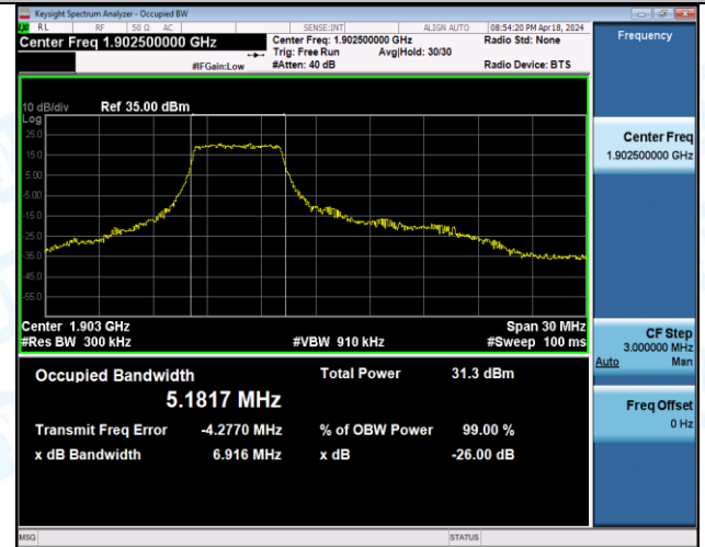
Band2-20MHz-QPSK-18900-100RB#0-PASS
