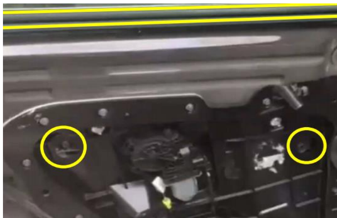
(6). 拿出标示处胶条和胶塞把两圆圈内玻璃螺丝拧出就可以直接把玻璃拿出来了
