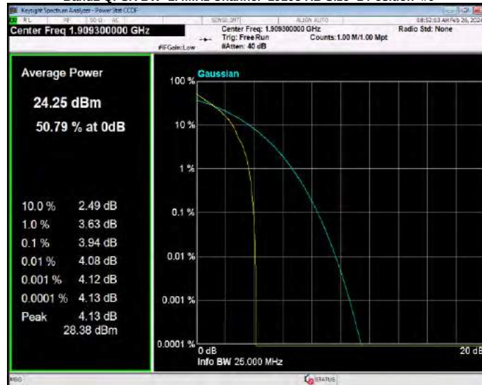
Band2 QPSK BW=10MHz Channel=18650 RB Size=1 Position=#0
