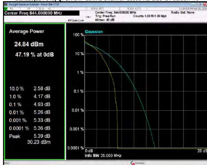
Band26(824-849) QPSK BW=15MHz Channel=26865 RB Size=1 Position=#0
