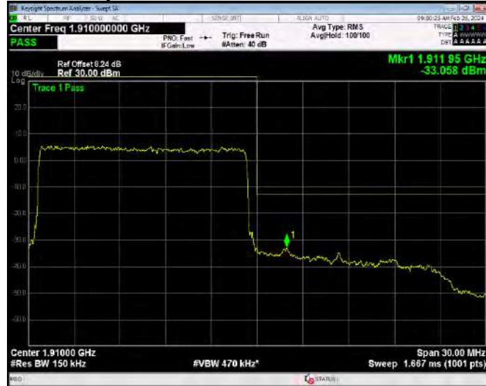
Band2 QPSK BW=20MHz Channel=18700 RB Size=1 Position=#0
