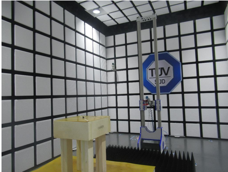
1GHz-18GHz RSE Setup
