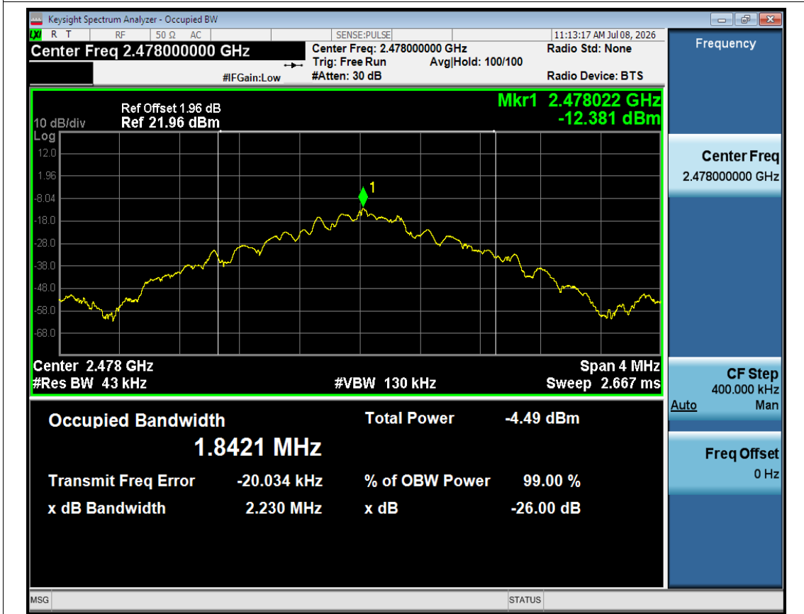
OBW NVNT 2.4GHz 2M 2478MHz Ant1
