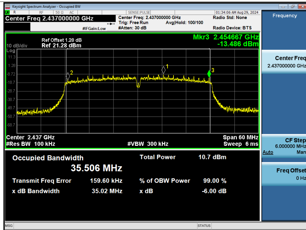
-6dB Bandwidth NVNT n40 2452MHz Ant1
