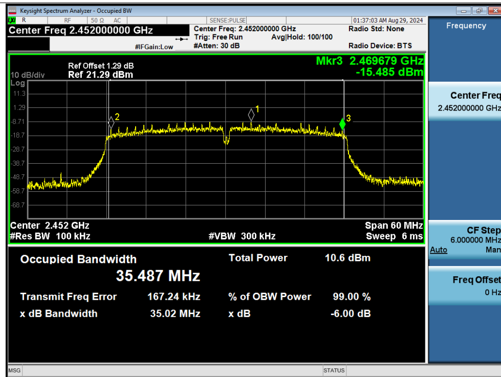
-6dB Bandwidth NVNT n40 2452MHz Ant1
