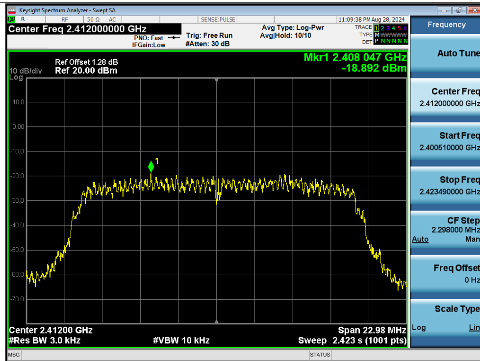
PSD NVNT g 2412MHz Ant1
