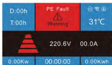
Missing of PE Protection
