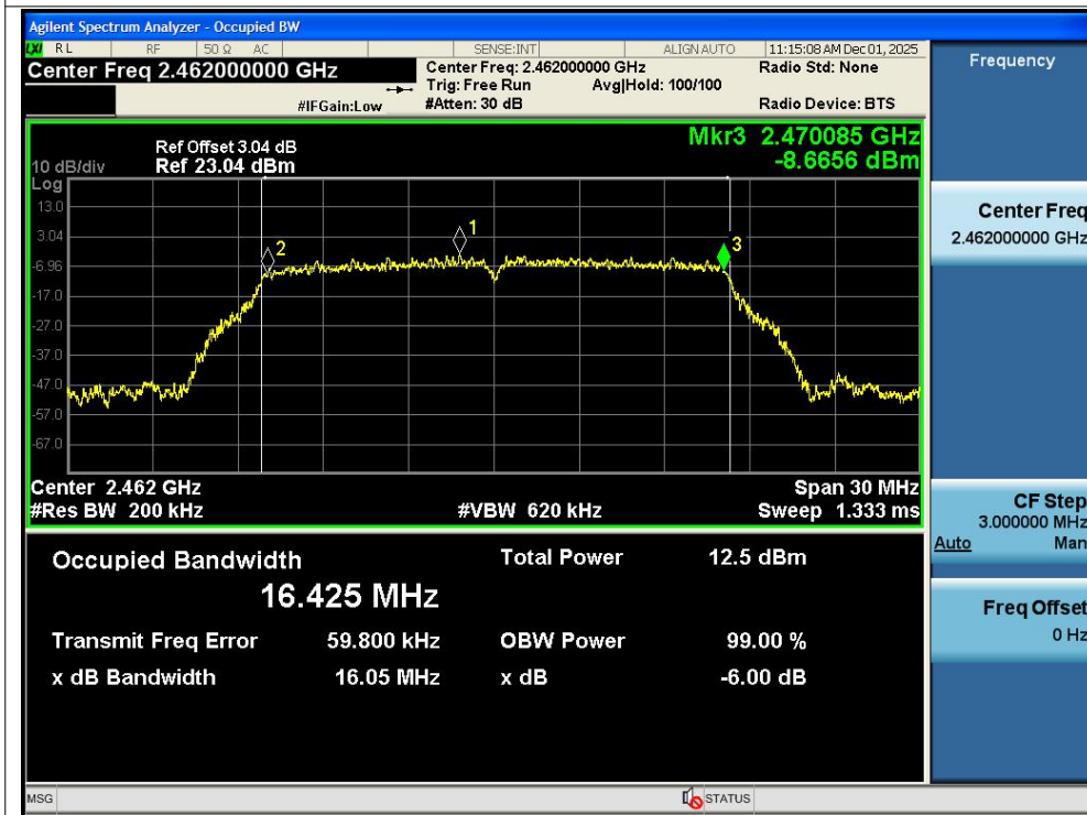
-6dB Bandwidth NVNT g 2462MHz Ant1
