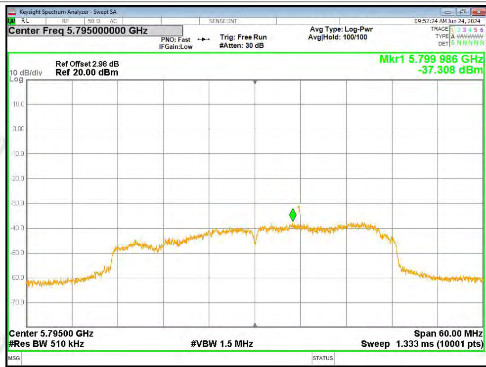
PSD NVNT n40 5795MHz Ant1
