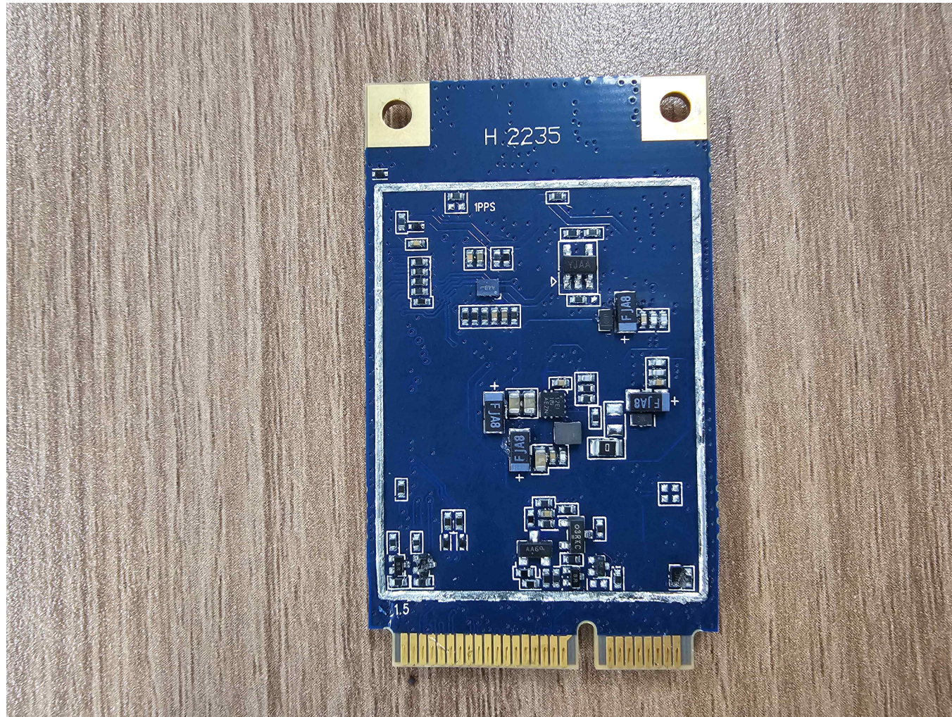
[MINI PCI_Bottom_Shield revmoved]
