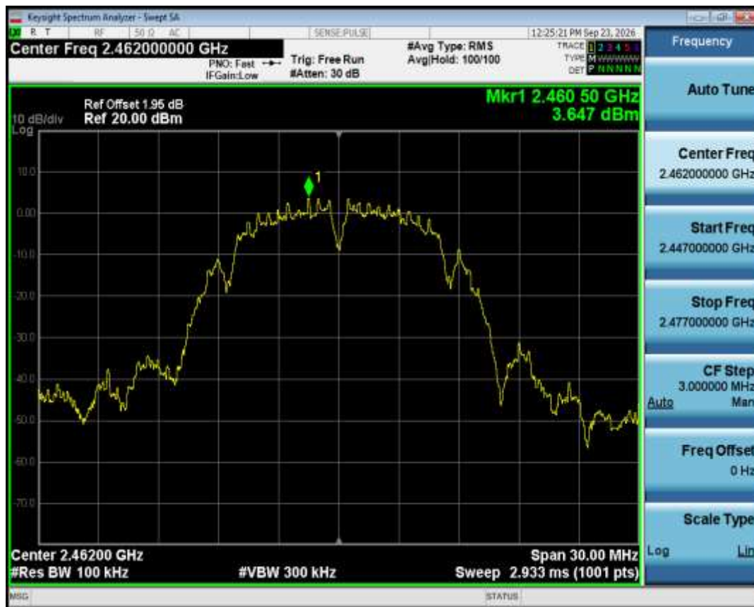
Band Edge NVNT b 2462MHz Ant1 Ref
