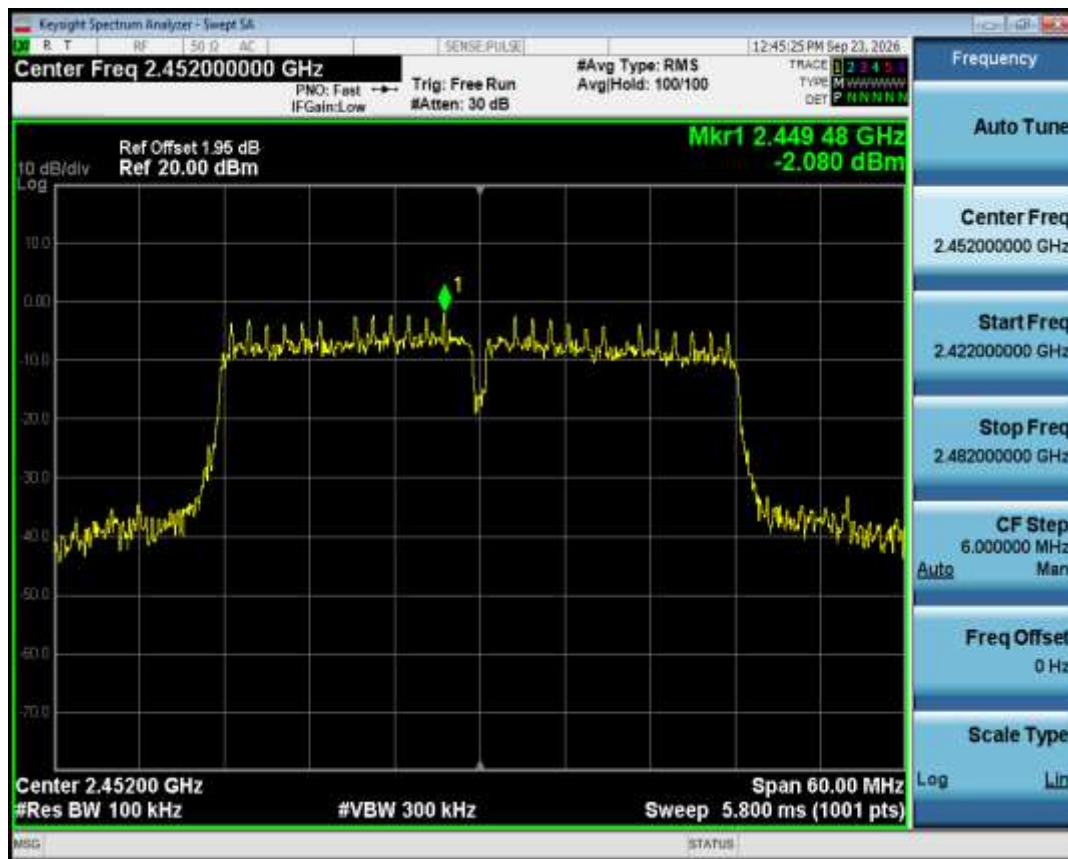
Band Edge NVNT n40 2452MHz Ant1 Ref
