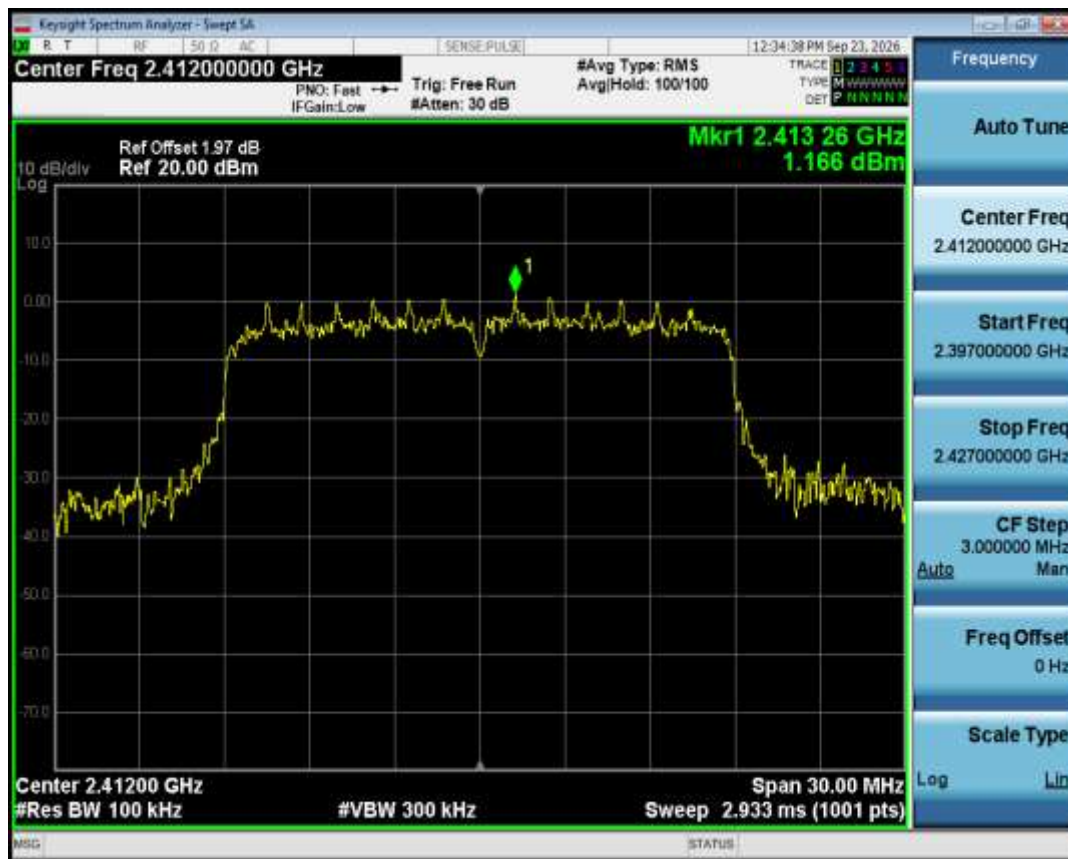
Band Edge NVNT n20 2412MHz Ant1 Ref
