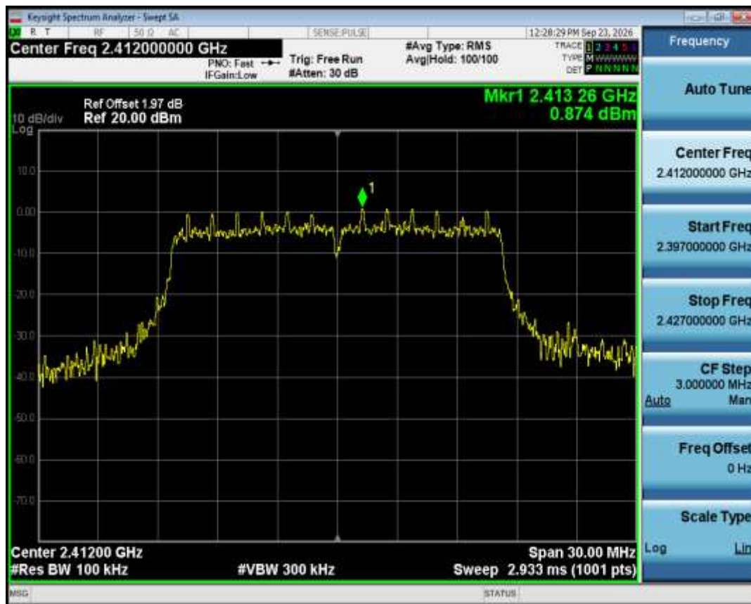
Band Edge NVNT g 2412MHz Ant1 Ref
