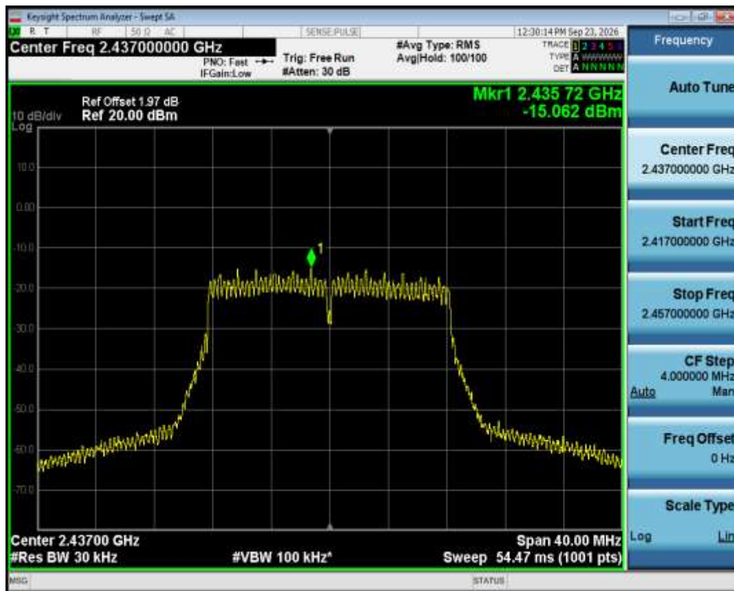
PSD NVNT g 2437MHz Ant1
