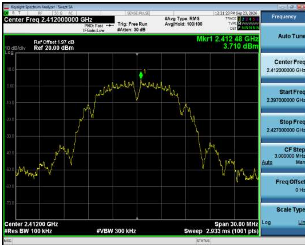
Band Edge NVNT b 2412MHz Ant1 Ref
