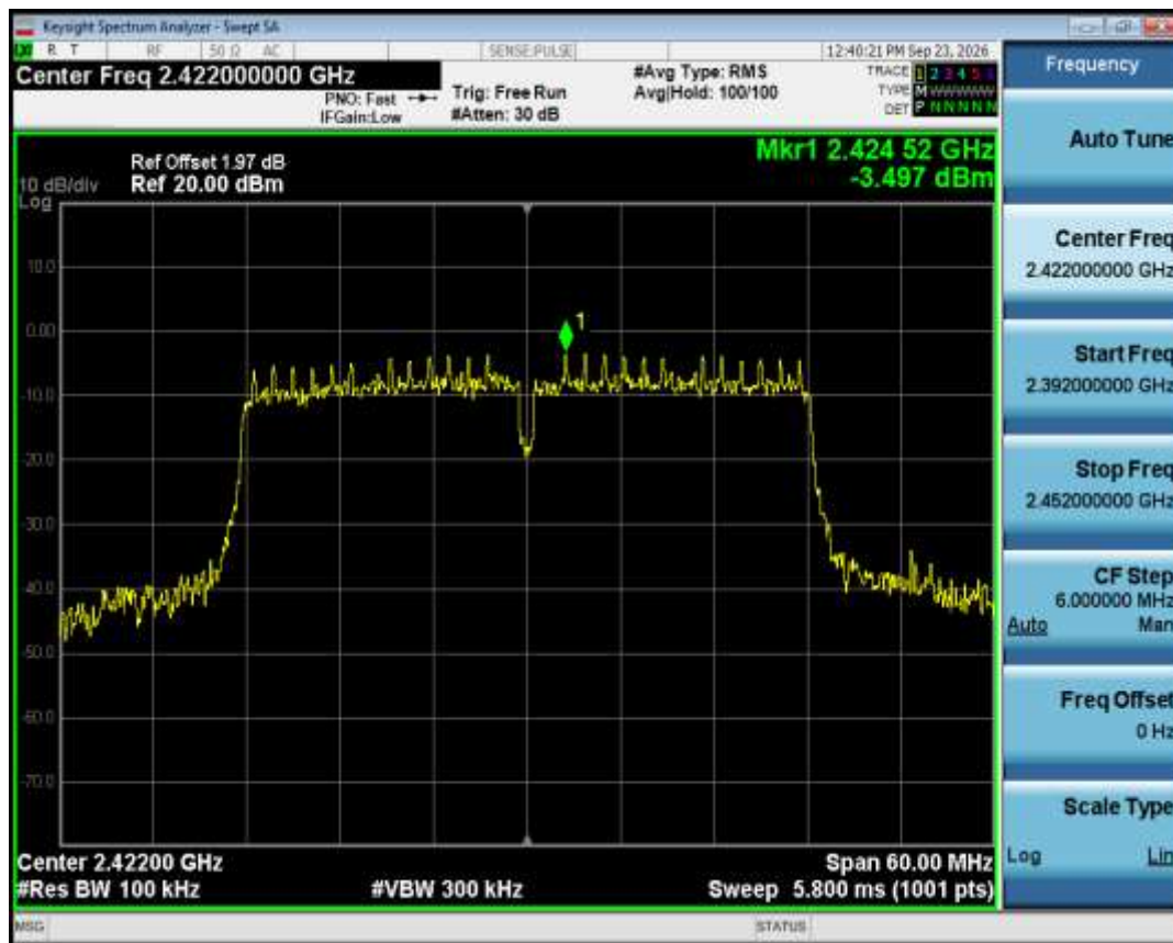
Band Edge NVNT n40 2422MHz Ant1 Ref
