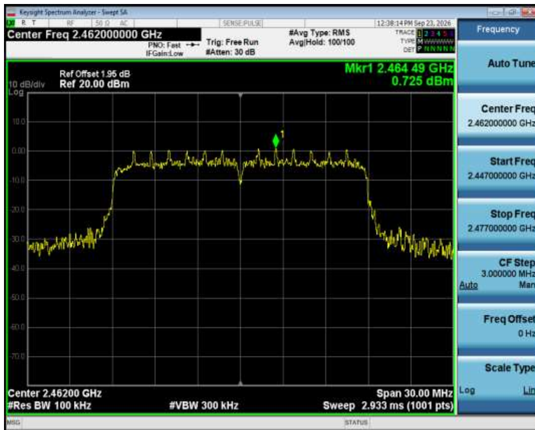
Band Edge NVNT n20 2462MHz Ant1 Ref
