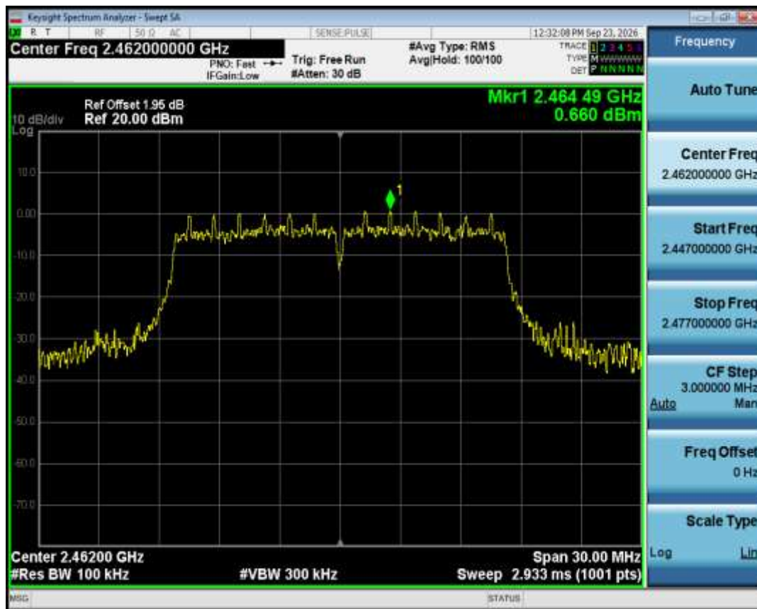
Band Edge NVNT g 2462MHz Ant1 Ref
