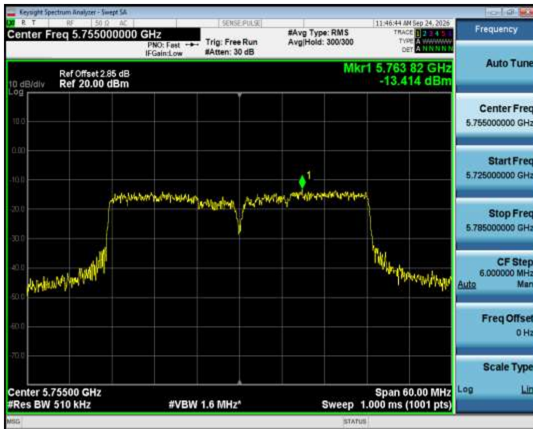
PSD NVNT n40 5755MHz Ant1
