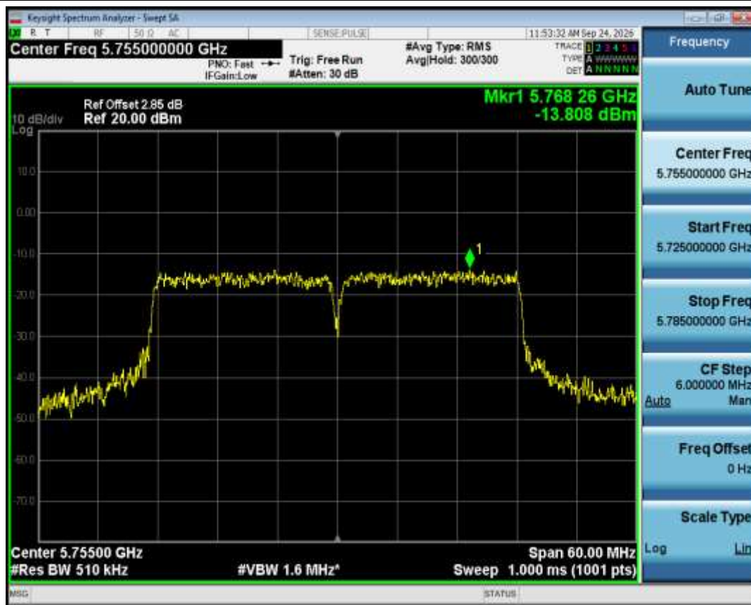
PSD NVNT ac40 5755MHz Ant1
