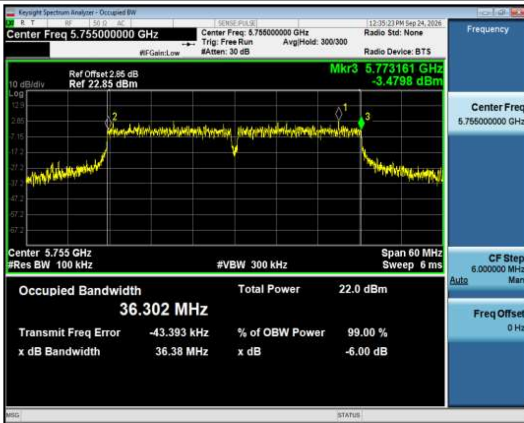
-6dB Bandwidth NVNT ac40 5755MHz Ant1
