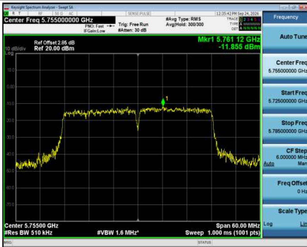
PSD NVNT ac40 5755MHz Ant1
