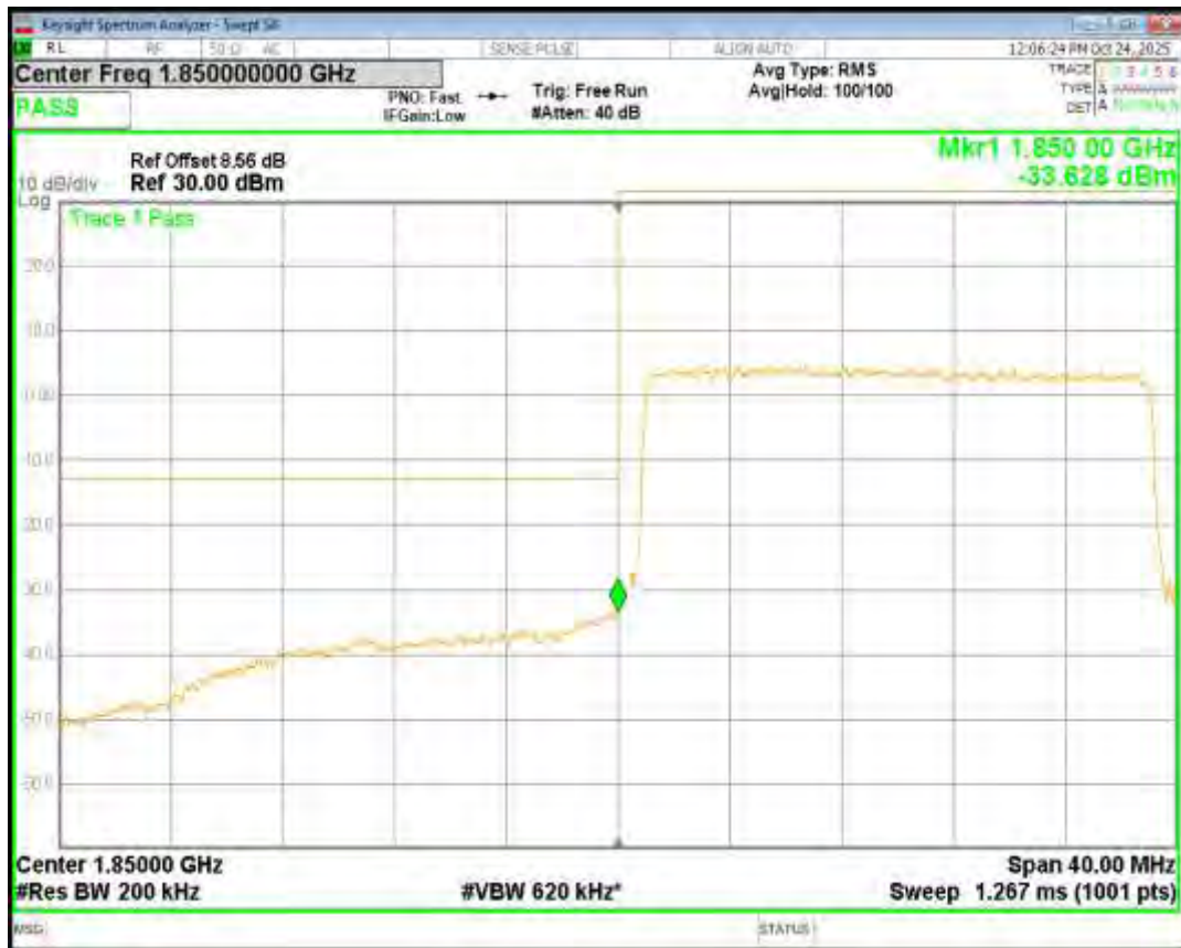
Band2 QPSK BW=20MHz Channel=19100 RB Size=100 Position=#0
