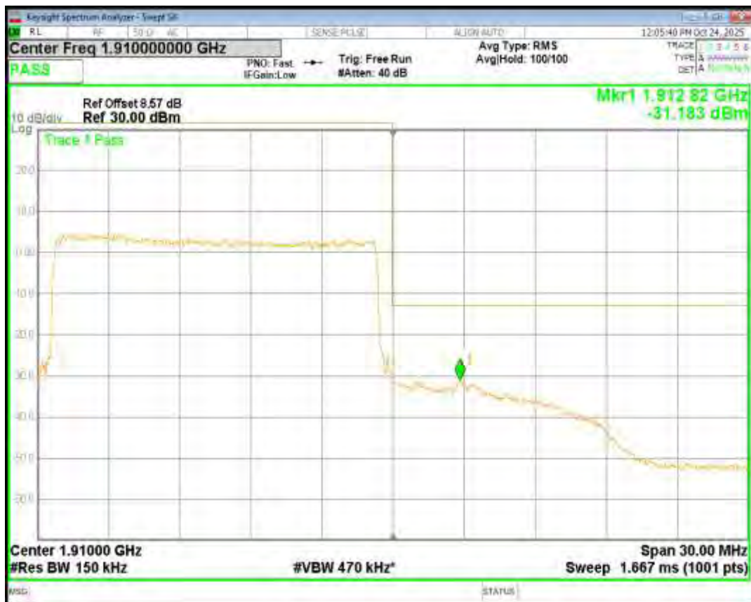
Band2 16QAM BW=20MHz Channel=18700 RB Size=100 Position=#0
