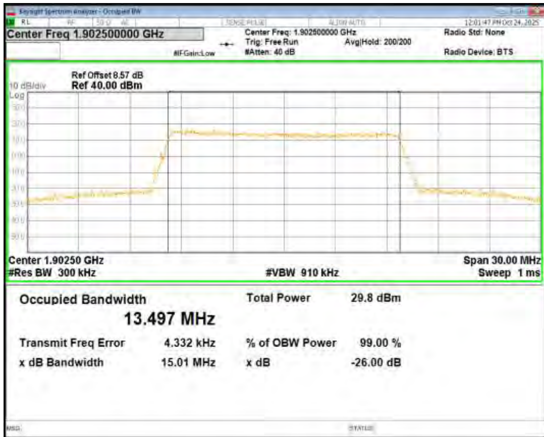
Band2 16QAM BW=20MHz Channel=18700 RB Size=100 Position=#0
