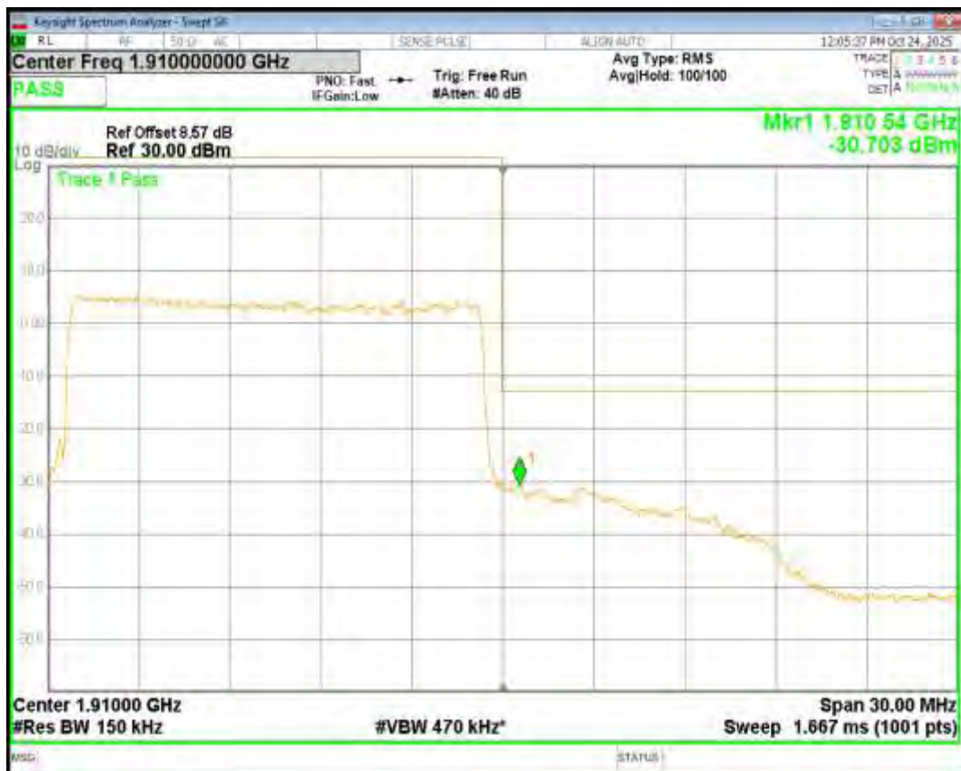
Band2 QPSK BW=20MHz Channel=18700 RB Size=100 Position=#0
