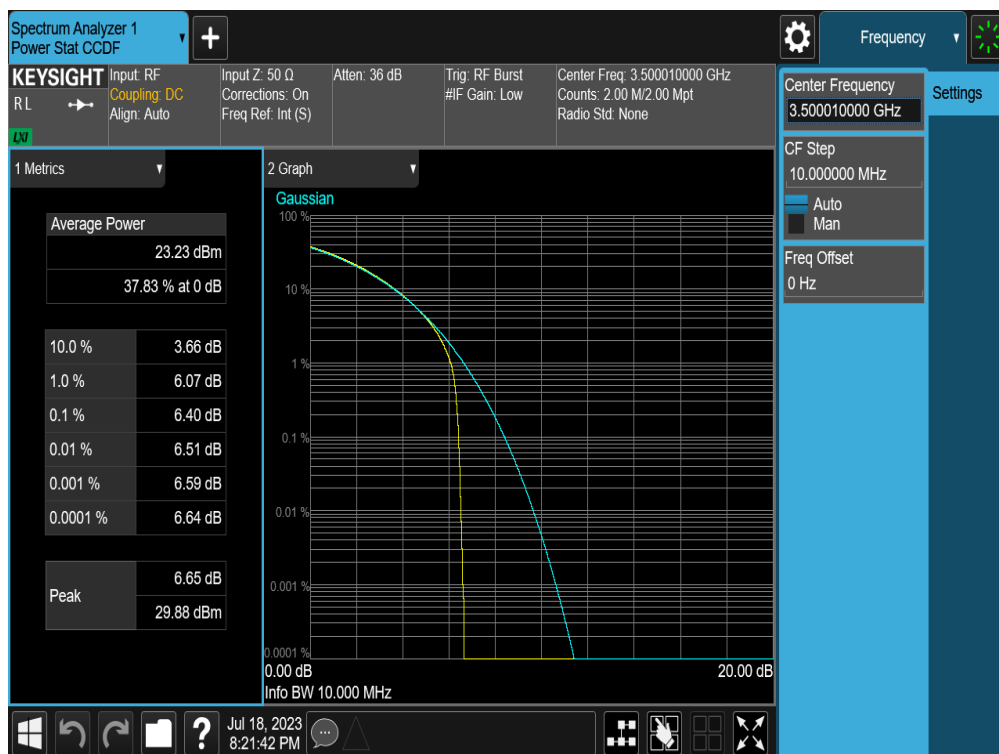
Plot 7-50. PAR Plot (NR Band n78 - 10MHz CP-OFDM QPSK– Full RB)
