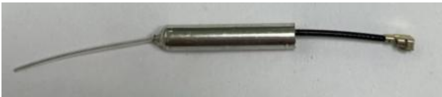
2.4G 铜管天线+同轴线图片及组装图片
